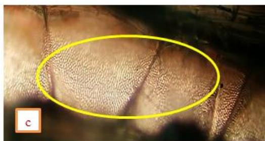
**Figura 32.** Corte transversal *Cedrela montana* (Cedro). **a.** Observado con el lente óptico de 4x, radios multiseriados estratificados. **b.** Visto con el lente de 10x, radios biseriados y multiseiados, con células envolventes y con fibras septadas **c.** Presencia de punteaduras en el vaso, visto con el lente 10x.
