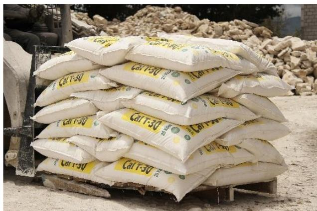
**Figura 43-3.** Cal hidratada (Producto final)
