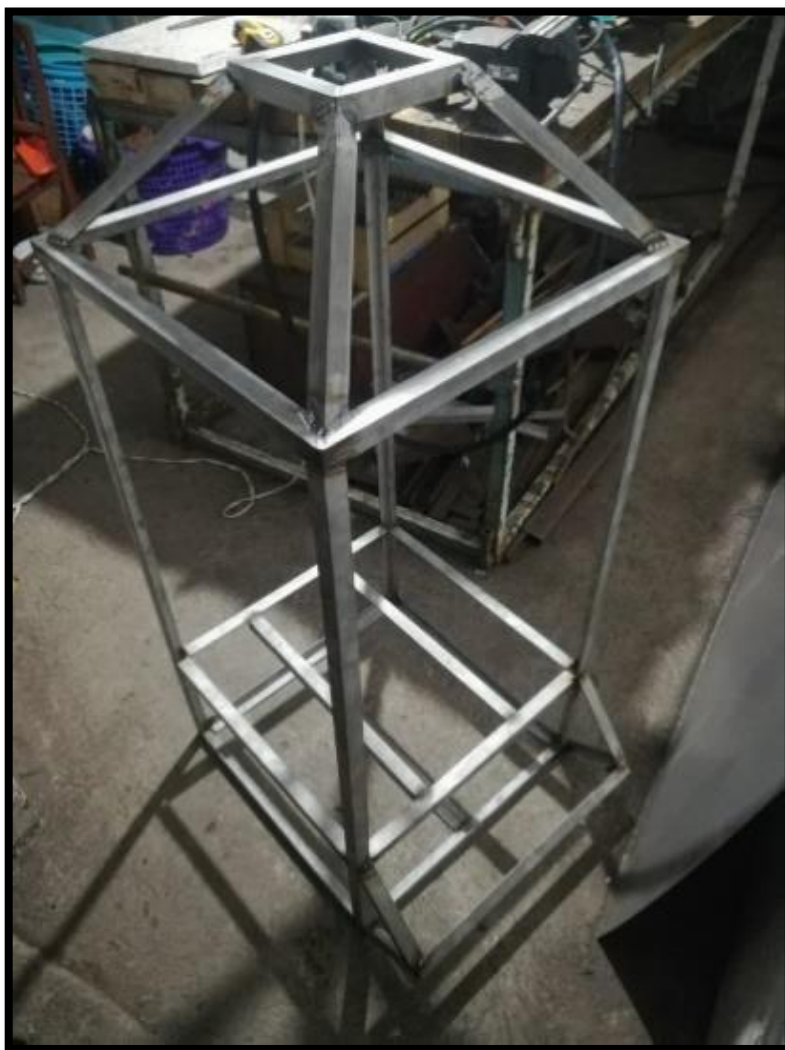
Figura 12-3. Construcción cuerpo principal y campana de extracción
