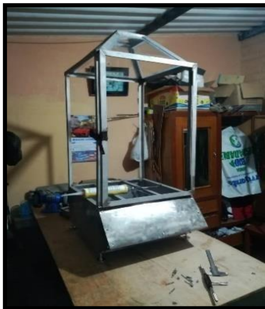
Figura 14-3. Colocación de tapas de protección.
