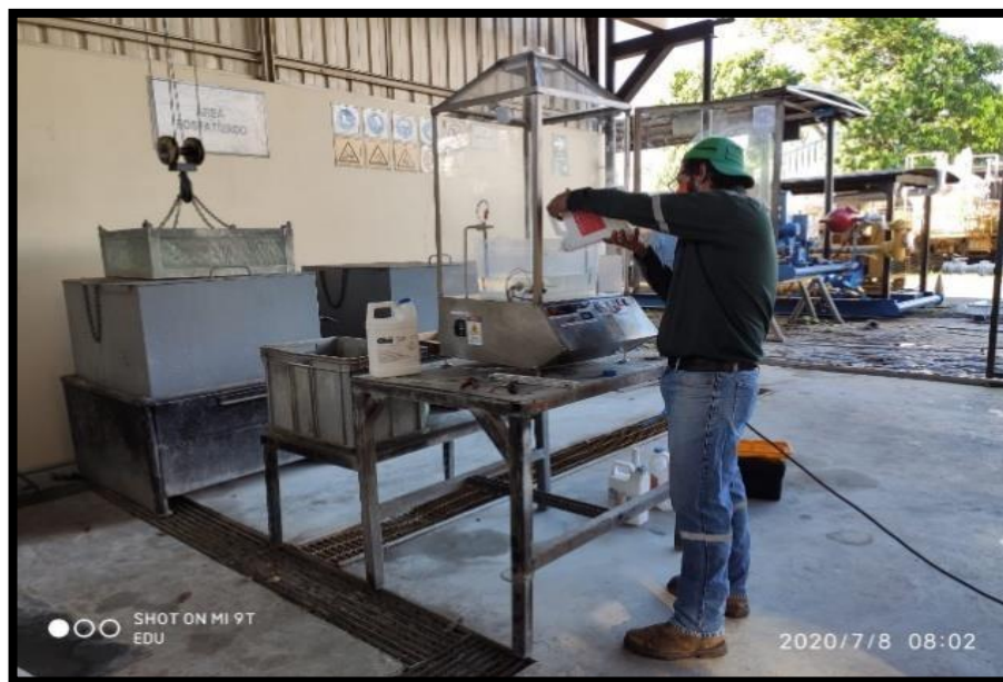
Figura 19-4. Colocación de electrolito, temperatura de funcionamiento Realizado por: Latorre, Noe; 2020
