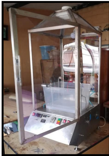
Figura 17-3. Planta de cobreado Realizado por: Latorre, Noe; 2020
