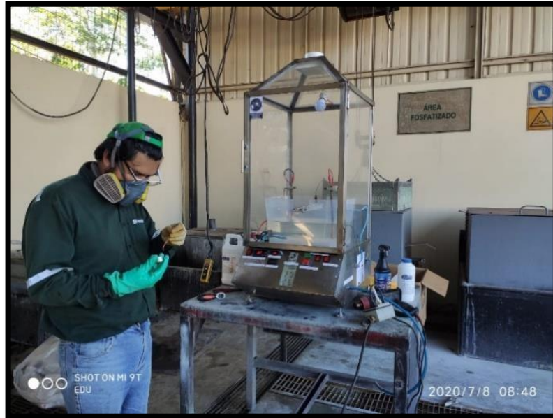
Figura 21-4. Proceso de colocación de herramientas a ser cobreadas
