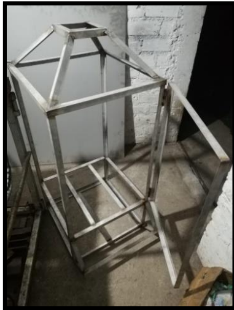
Figura 13-3. Colocación de la puerta
