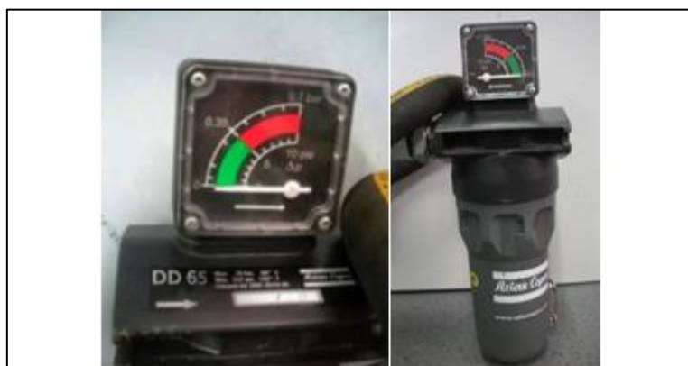
Figura 41-3: Filtro DD 65 existente en bodega de la fábrica.
