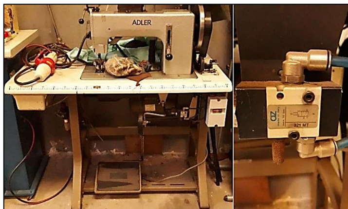
Figura 16-3: Máquina de empiolar ADLER y su válvula de control marca “az 321 MT 1/8”
