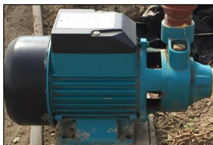
Figura 15-3. Bomba Centrífuga del sistema por gravedad
