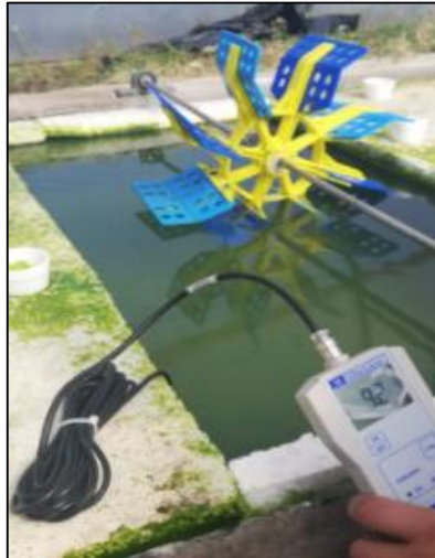
Figura 43-3. Medición de oxígeno disuelto después de oxigenar
