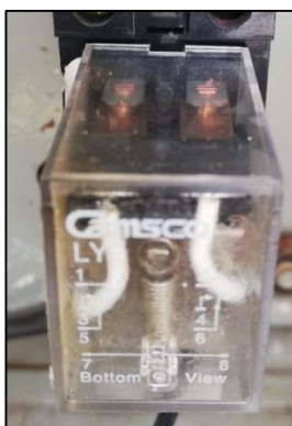
Figura 41-3. Relé del sistema de control
