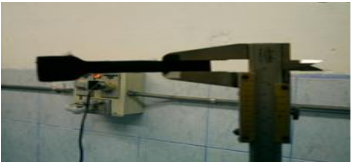
Figura 7-2. Medición de la longitud inicial del cuero
