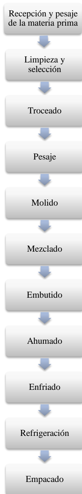
Figura 1-2: Diagrama de flujo de la elaboración de salame cocido.
