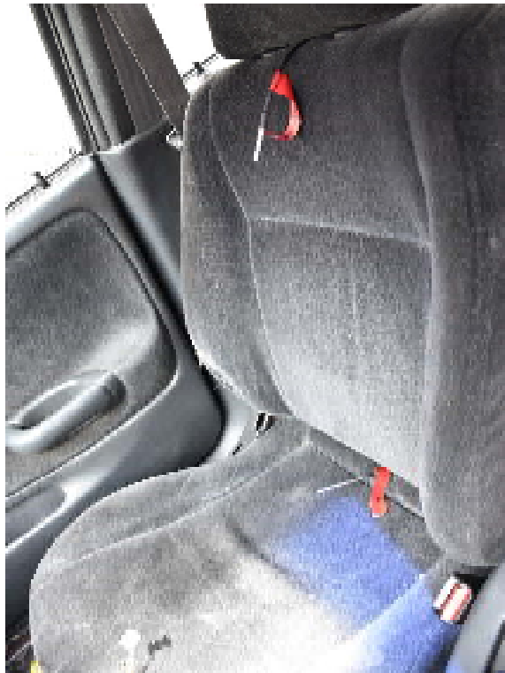
Ilustración 2: Ubicaciones de sensores en los asientos conductor y pasajero
