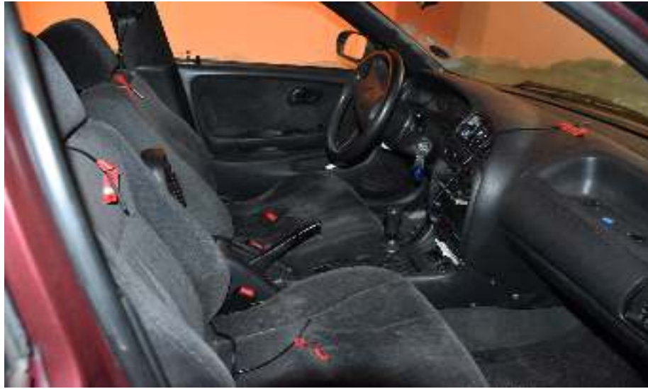
Ilustración 1: Ubicación de sensores dentro de la cabina para los ensayos 1 y 2
