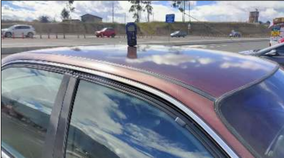
Figura 11-2: Ubicación del equipo SM206-SOLAR para la medición de la irradiación solar
