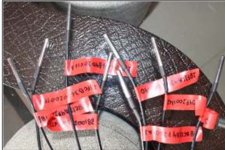
Figura 2-1: Sensores de temperatura DS18B20
