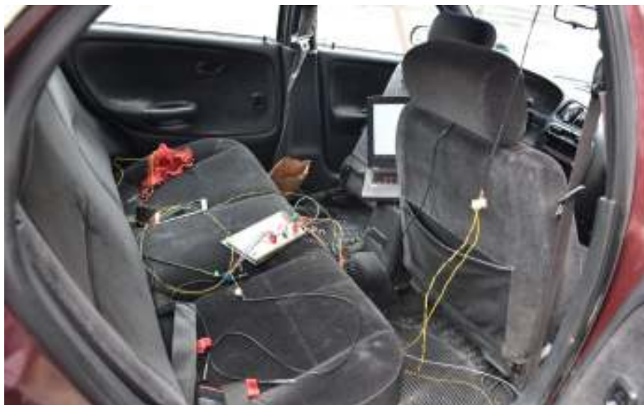
Ilustración 5: Conexiones para verificación del funcionamiento de sensores
