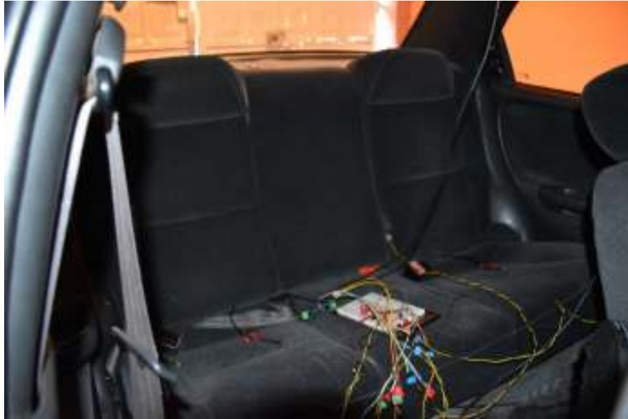
Ilustración 10: Ubicación de sensores en los asientos traseros de la cabina
