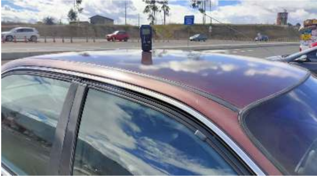
Ilustración 14: Ubicación del medidor de radiación solar para el ensayo 3 con incidencia solar
