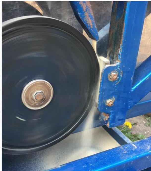
**Figura 5-3:** Fricción producida ente el disco y probeta.
