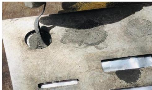
**Figura 5-2:** Llenado de probetas con la mezcla homogenizada.
