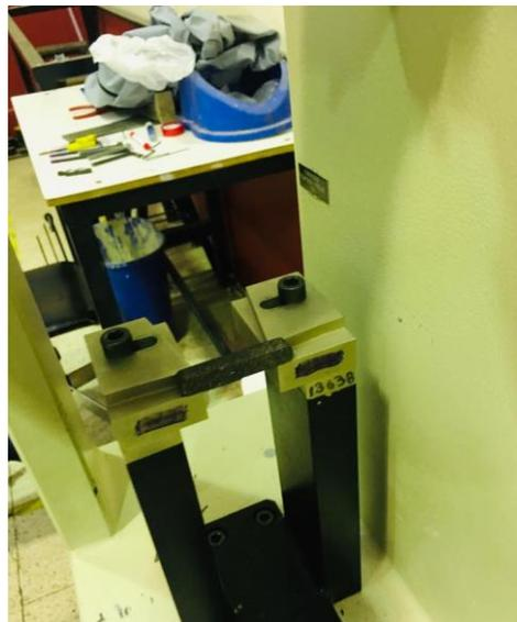
**Figura 9-3:** Colocación de la probeta a ensayar.
