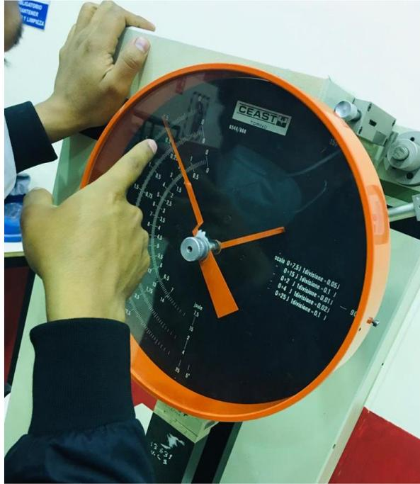
**Figura 10-3:** Verificación de la lectura de energía absorbida.
