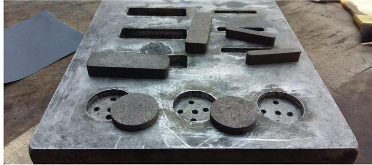
**Figura 9-2:** Extracción de las probetas del molde.
