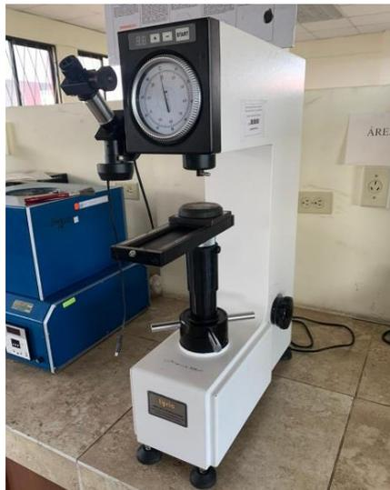
**Figura 19-3:** Durómetro.
