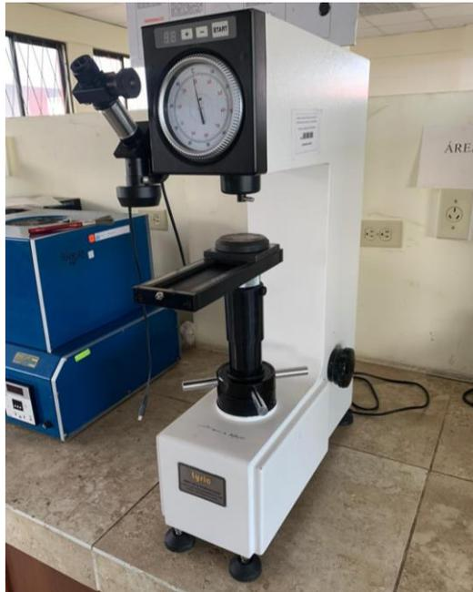
**Figura 21-1:** Máquina para ensayo Brinell.
