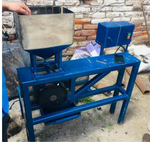
**Figura 12-3:** Máquina para el ensayo ASTM G65.
