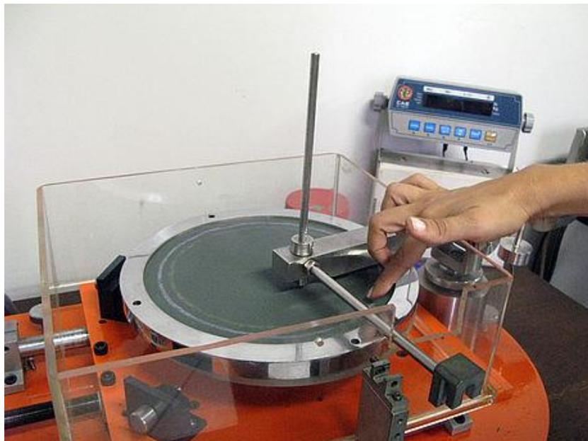
**Figura 20-1:** Máquina de Ensayo Pin on Disk.
