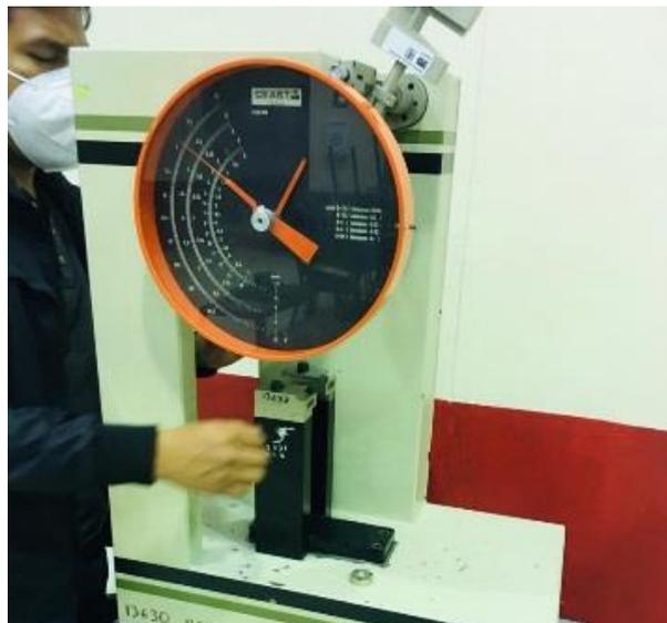
**Figura 7-3:** Aplicación de la energía para el martillo.
