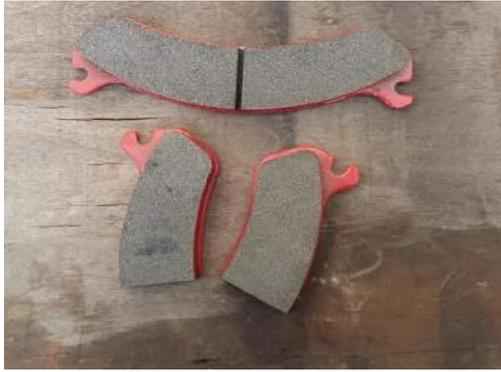
**Figura 10-2:** Patillas de freno comercial
