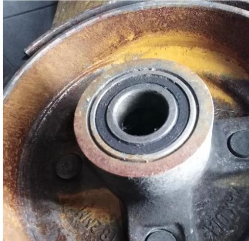
**Figura 16-1:** Desgaste por corrosión.
