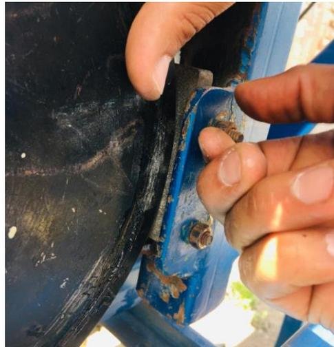
**Figura 15-3:** Colocación de la probeta.
