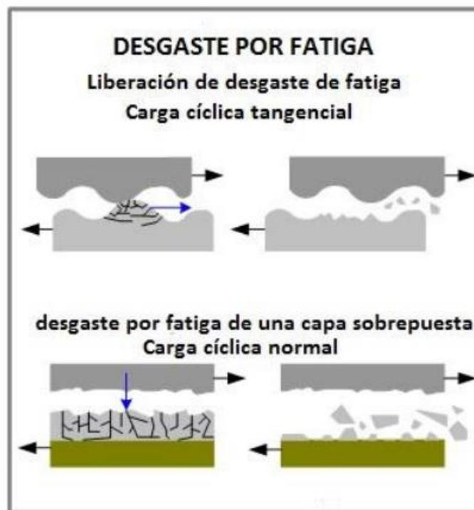
**Figura 15-1:** Desgaste por fatiga.
