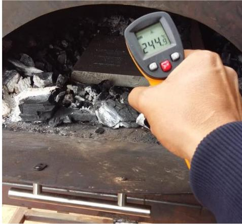
**Figura 7-2:** Control de temperatura de la cámara.
