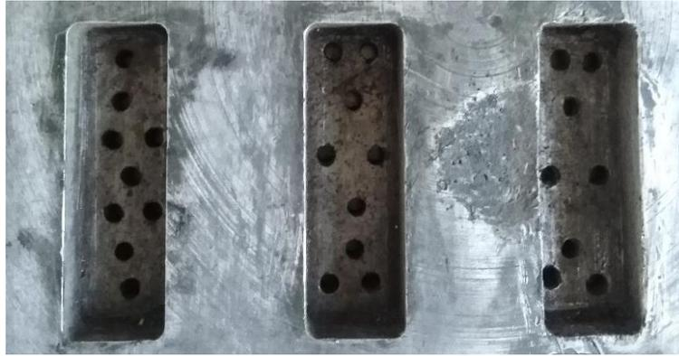
**Figura 3-3:** Molde de probetas para ensayo de desgaste por arena seca
