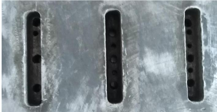
**Figura 2-3:** Molde para probetas de ensayo de Charpy.
