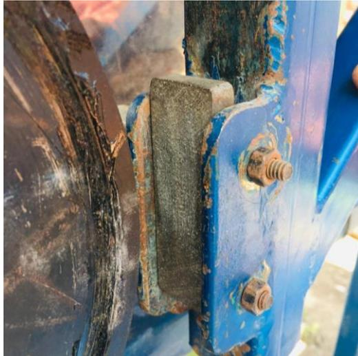
**Figura 18-3:** Probeta desgastada después de la fricción.
