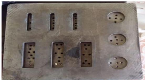
**Figura 2-2:** Molde de las probetas elaboradas.
