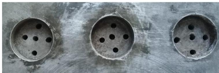
**Figura 4-3:** Molde para probetas de ensayo pin on disk
