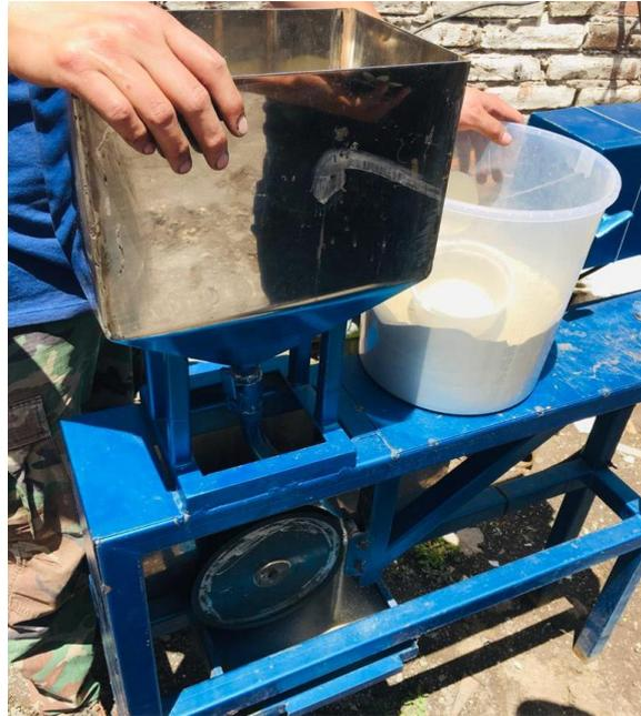
**Figura 14-3:** Verificación del caudal de la arena sílice.
