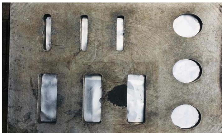
**Figura 1-3:** Molde utilizado para la elaboración de las probetas.
