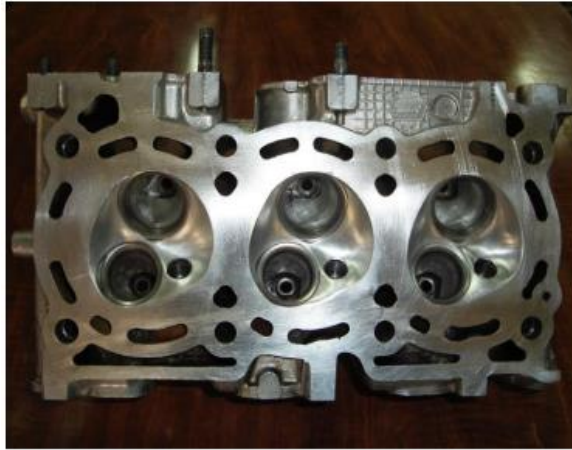
Figura 4-3: Cámara de Combustión
