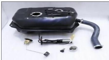
Figura 9-2: Depósito de combustible.
