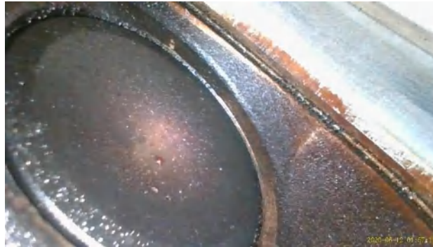
Figura 64-3. Válvula de escape de cilindro 2 vehículo Ford f 150
