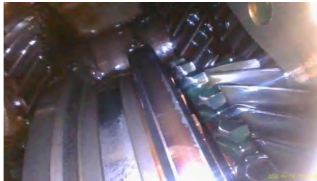
Figura 111-3. Engranajes y sincronizadores de caja de velocidad de corsa Evolution 1.8
