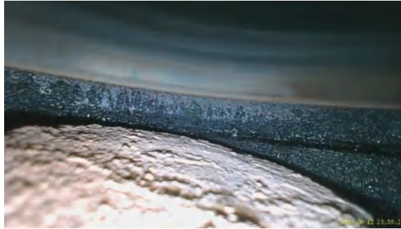
Figura 8-3. Válvulas de escape correspondientes al cilindro 2 de vehículo Toyota Stout 2004
