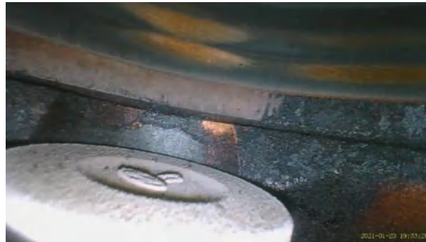
Figura 162-3. Válvula de escape y camisa del cilindro 3 Hyundai Getz 1.4L 2011
