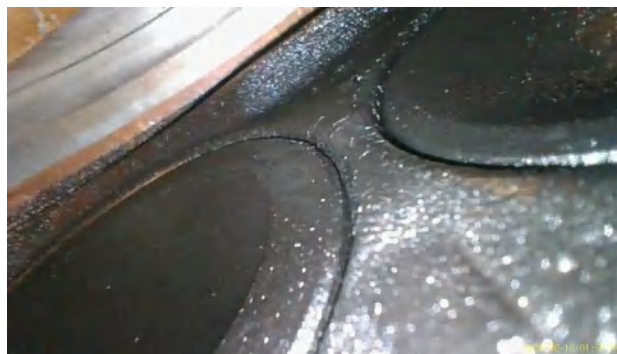
Figura 63-3. Válvulas de admisión de cilindro 2 vehículo Ford f 150
