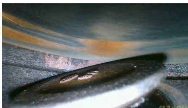
Figura 155-3. Válvula admisión del cilindro 1 Hyundai Getz 1.4L 2011
