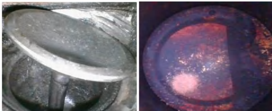
Figura 29-1. Corrosión en la cabeza del pistón y doblado de válvulas
