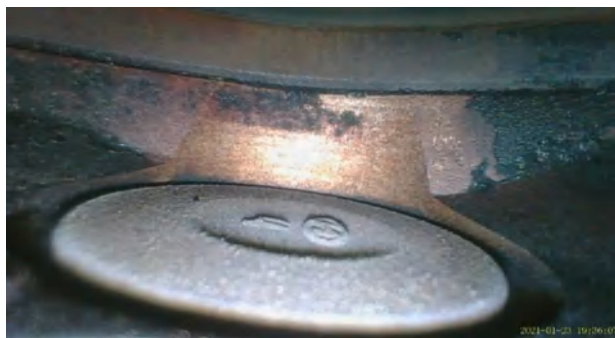
Figura 167-3. Válvula de escape del cilindro 4 Hyundai Getz 1.4L 2011
