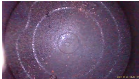
Figura 5-3. Pistón correspondiente al cilindro 2 de vehículo Toyota Stout 2004
