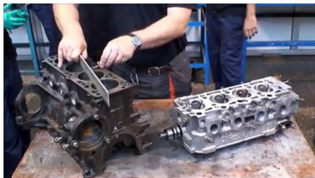
Figura 39-1. Comprobación de la superficie plana del cabezote
