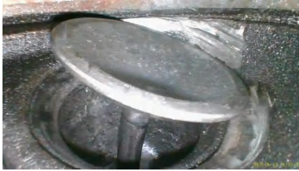
Figura 59-3. Válvula de escape deformada de cilindro 1 vehículo Ford f 150
