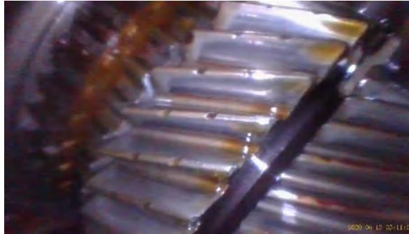
Figura 26-3. Engranajes y sincronizadores en la caja de cambios de Toyota Stout 2004
