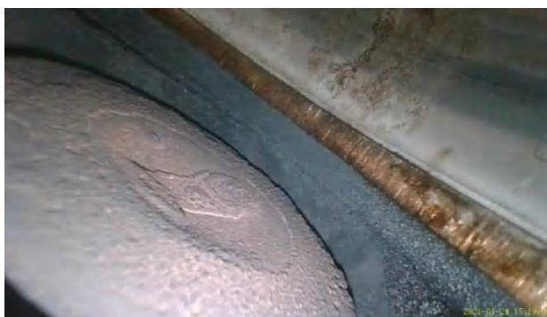
Figura 206-3 Válvula de escape cilindro 2 Toyota Stout 1978
