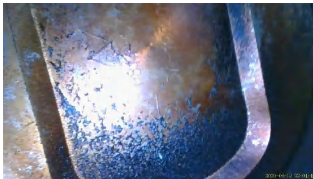
Figura 65-3. Pistón de cilindro 3 vehículo Ford f 150
