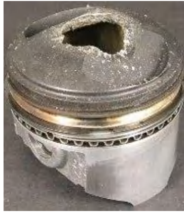
Figura 47-1. Pistón perforado en la cabeza
