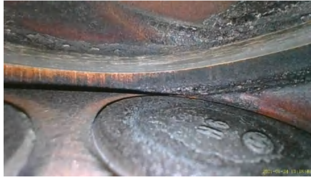
Figura 186-3 Válvula de admisión cámara de combustión cilindro 4 Hyundai Getz 1.6L 2009
