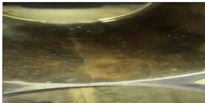
Figura 33-1. Fisura en una camisa de bloque motor
