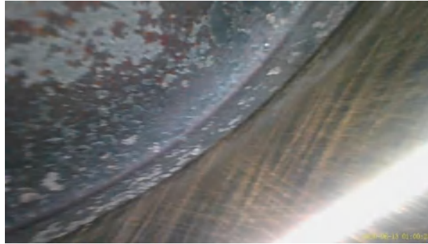
Figura 102-3. Cabeza de pistón 4 vehículo Chevrolet Corsa Evolution 1.8
