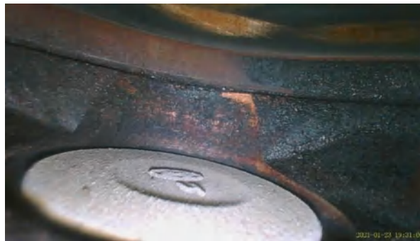
Figura 160-3. Válvula de escape del cilindro 2 Hyundai Getz 1.4L 2011
