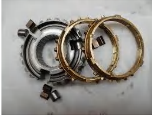
Figura 58-1. Sincronizadores en buen estado
