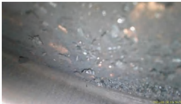
Figura 211-3 Cabeza del pistón cilindro 4 Toyota
