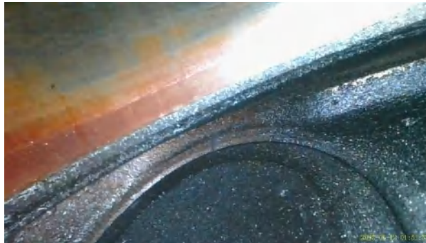
Figura 60-3. Válvula de admisión de cilindro 1 vehículo Ford f 150
