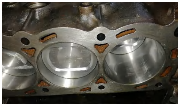
Figura 38-1. Bloque del motor en perfectas condiciones
