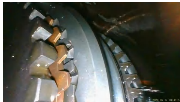
Figura 89-3. Sincronizadores de caja de velocidad manual vehículo Ford f 150
