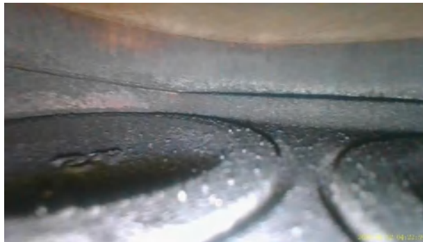
Figura 138-3. Válvulas de admisión de cilindro 2 Nissan Almera
