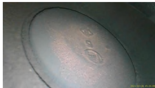
Figura 214-3 Válvula de escape cilindro 4 Toyota
