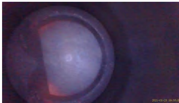
Figura 164-3. Cabeza de pistón del cilindro 4 Hyundai Getz 1.4L 2011
