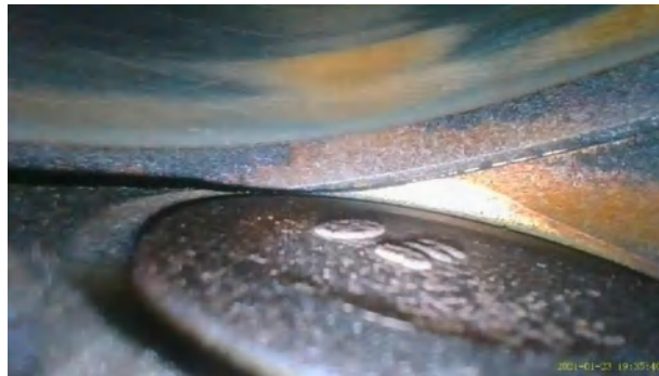
Figura 166-3. Válvula de admisión del cilindro 4 Hyundai Getz 1.4L 2011
