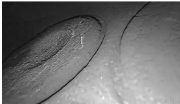
Figura 201-3 Válvula de escape cilindro 1 Toyota Stout 1978
