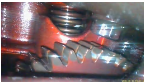
Figura 20-3. Engranaje de distribución y resorte de válvulas
