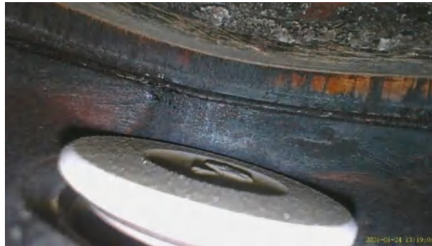
Figura 187-3 Válvula de escape cilindro 4 Hyundai Getz 1.6L 2009
