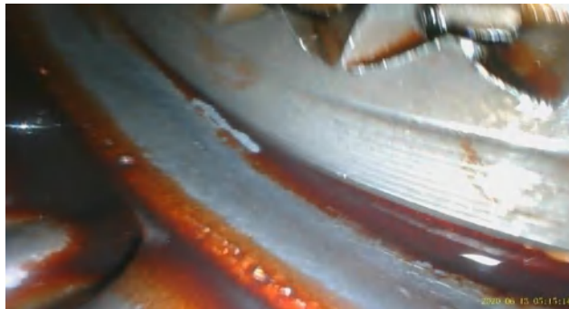
Figura 29-3. Sincronizador en la caja de cambios de vehículo Toyota Stout 2004
