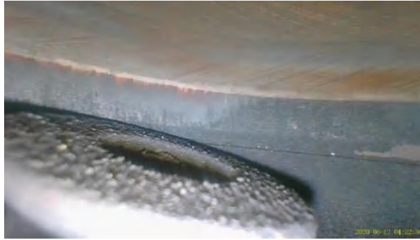
Figura 137-3. Válvula de escape de vehículo Nissan Almera
