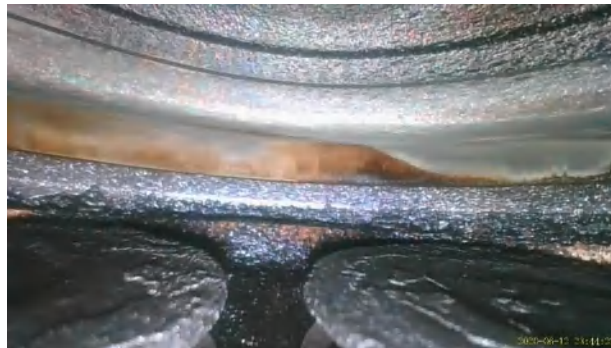
Figura 15-3. Válvulas de admisión correspondientes al cilindro 4 de vehículo Toyota Stout 2004
