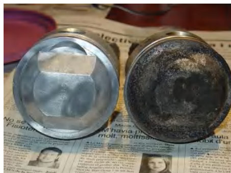
Figura 48-1. Comparación entre pistón en buen estado y uno con carbonilla
