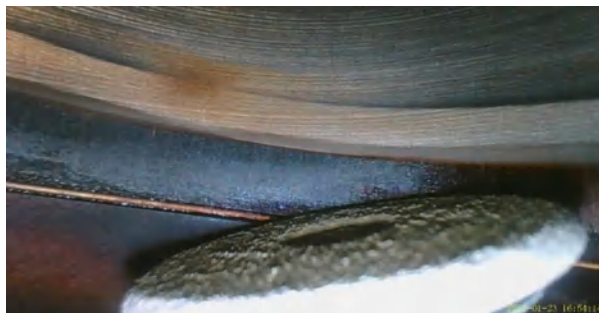
Figura 237-3 Válvula de escape cilindro 4 Chevrolet Grand Vitara TM AC Sport 2L
