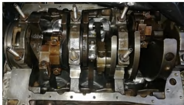
Figura 50-1. Bielas, cigüeñal y pistones en perfectas condiciones ensamblados en bloque motor
