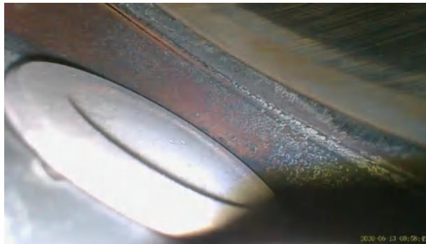
Figura 101-3. Válvula de escape de cilindro 3 vehículo Chevrolet Corsa Evolution 1.8
