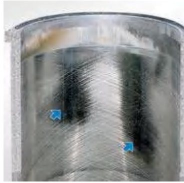
Figura 35-1. Camisa con excesivas rayaduras
