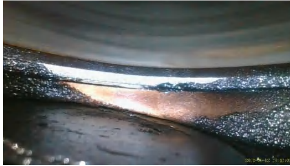
Figura 12-3. Válvulas de admisión del cilindro 3 de vehículo Toyota Stout 2004
