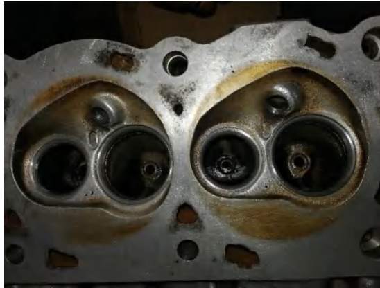
Figura 40-1. Cabezote reparado con asientos de válvulas nuevos
