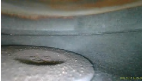
Figura 133-3. Válvula de escape de vehículo Nissan Almera
