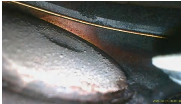
Figura 33-3. Válvula de escape cilindro 1 Chevrolet Grand Vitara 2006
