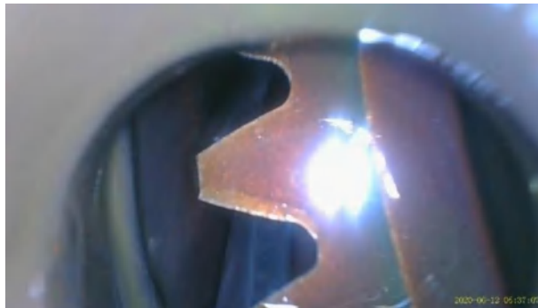
Figura 128-3. Sincronizador de caja de velocidad de vehículo Kia Xcite
