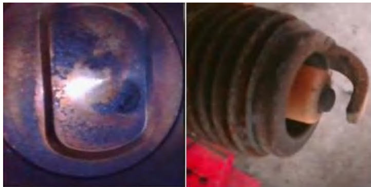
Figura 25-1. Carbonización de Pistón y bujías
