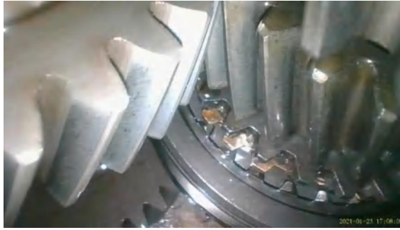
Figura 242-3 Sincronizador y engranajes de marcha
