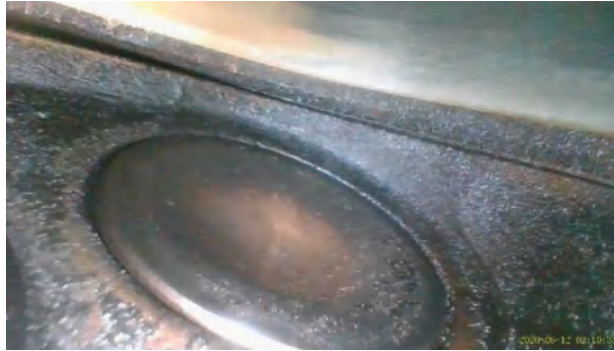
Figura 72-3. Válvula de escape de cilindro 4 vehículo Ford f 150
