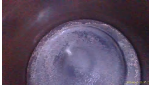
Figura 98-3. Cabeza de pistón cilindro 3 vehículo Chevrolet Corsa Evolution 1.8
