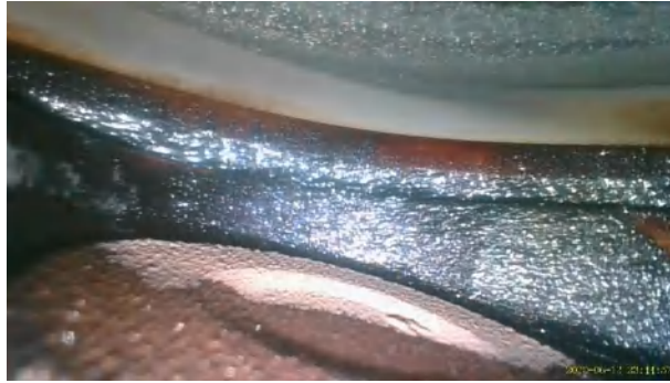
Figura 16-3. Válvulas de escape correspondientes al cilindro 4 de vehículo Toyota Stout 2004
