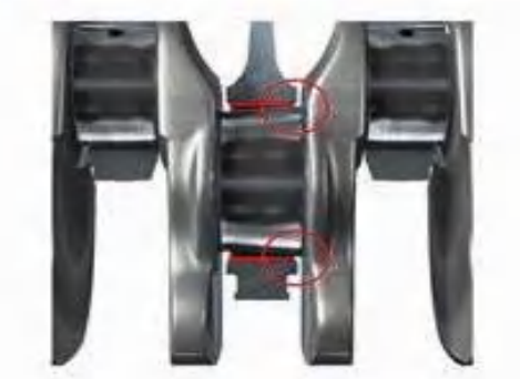
Figura 53-1. Desgaste en cojinetes de cigüeñal
