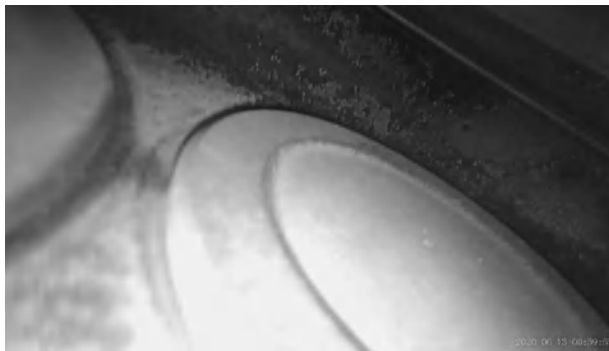
Figura 105-3. Válvula de admisión de escape 4 vehículo Chevrolet Corsa Evolution 1.8
