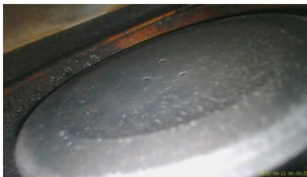
Figura 97-3. Válvula de admisión de cilindro 2 vehículo Chevrolet Corsa Evolution 1.8
