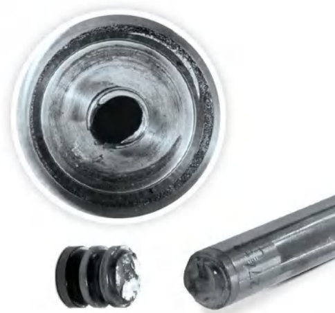
Figura 42-1. Válvula rota por desgaste
