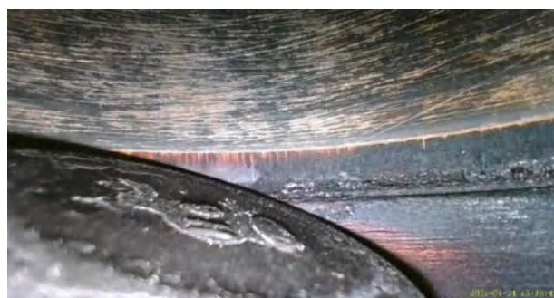
Figura 183-3 Válvula de admisión y camisa cilindro
