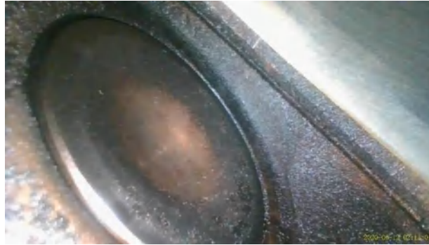
Figura 79-3. Válvula de escape de cilindro 6 vehículo Ford f 150
