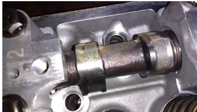
Figura 46-1. Defecto en levas por fatiga
