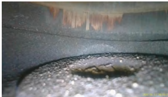
Figura 142-3. Válvula de escape de cilindro 3 de vehículo Nissan Almera
