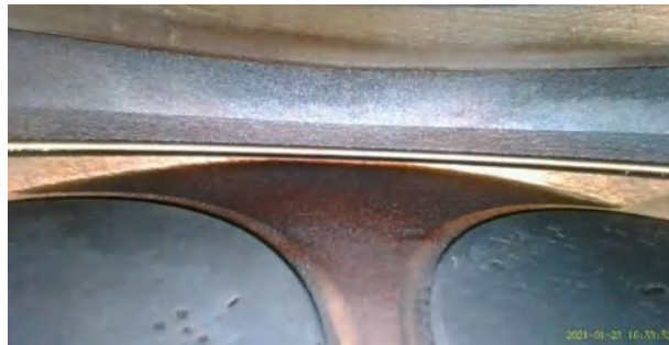
Figura 236-3 Válvulas de admisión cilindro 4 Chevrolet Grand Vitara TM AC Sport 2L
