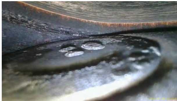
Figura 180-3 Válvula de admisión cilindro 2 Hyundai
