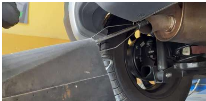
Figura 14-2. Instalación de la sonda y extractor de gases
