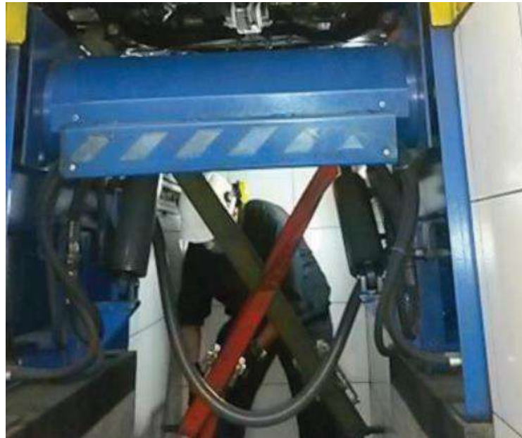
Figura 11-2. Anclaje del vehículo contra el piso
