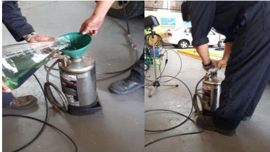
Figura 13-2. Abastecimiento de combustible al tanque de combustible externo
