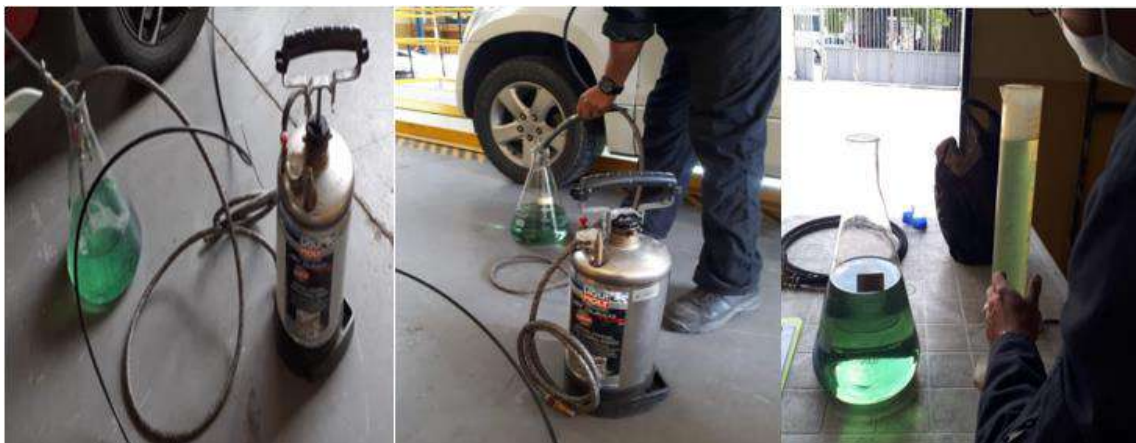
Figura 16-2. Medición del consumo de combustible
