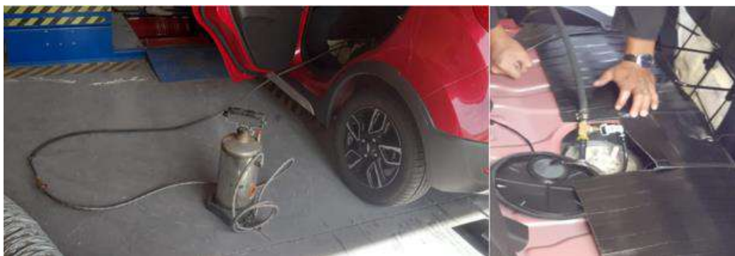
Figura 12-2. Conexión del Canister mediante acoples en el Spark GT
