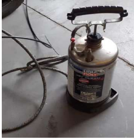
Figura 9-2. Canister (tanque de presión de combustible)
