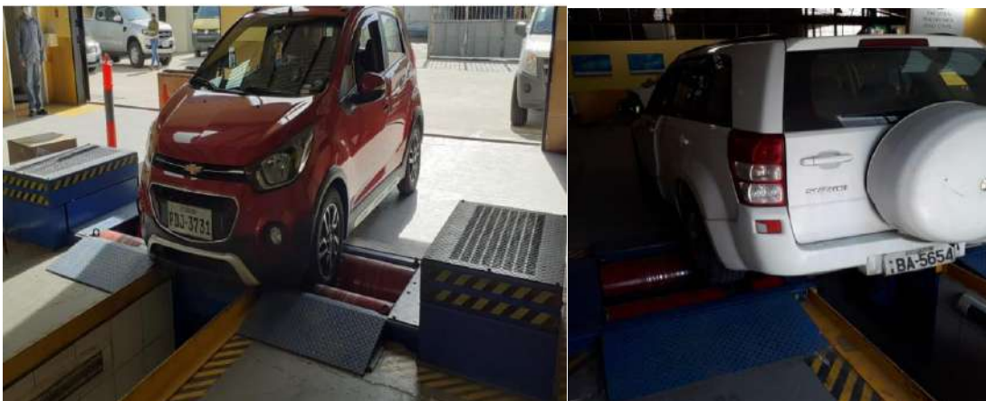
Figura 10-2. Montaje de los vehículos de prueba en el banco dinamométrico
