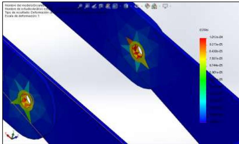
**Figura 71-2:** Deformaciones en las barras de acople
