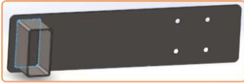
**Figura 21-2:** Vista isométrica junta soldada para el perfil de unión
