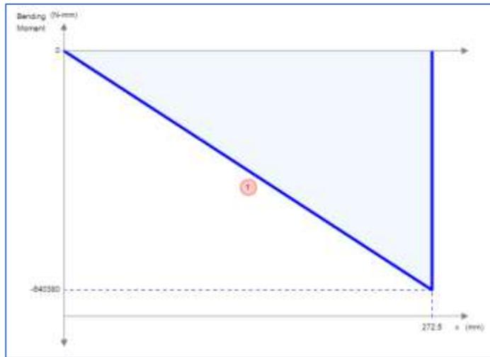
**Figura 32-2:** Diagrama de momentos eje x
