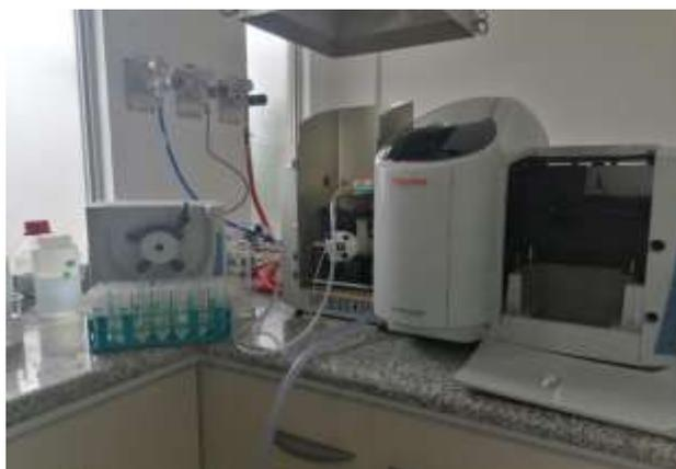
**Figura 42-2.** Determinación de metales pesados por Espectroscopia de Absorción Atómica.
