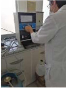
**Figura 44:** Medición de Na y K en el Fotómetro de llama.
