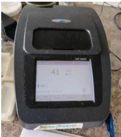
**Figura 24-2.** Medición de aniones en el espectrofotómetro visible HACH DR 2800
