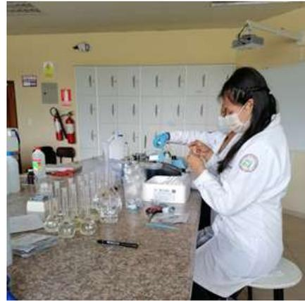
**Figura 39:** Medición de aniones en el espectrofotómetro HACH
