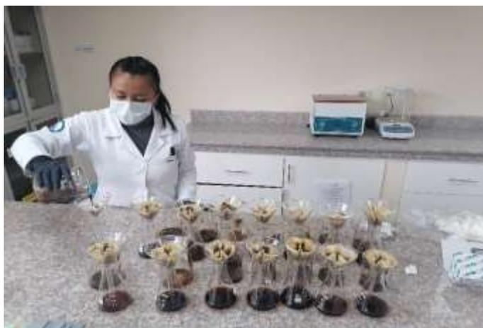
**Figura 23-2.** Preparación de muestras vegetales para la determinación de aniones
