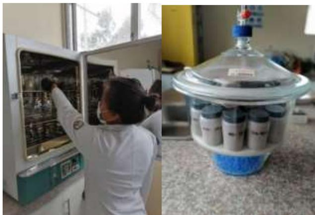
**Figura 9-2.** Secado de muestras vegetales y almacenamiento en frascos estériles en el desecador.
