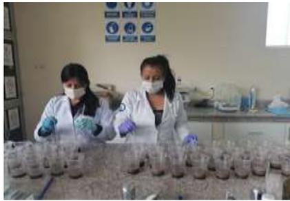
**Figura 18:** Preparación de la solución para medición de pH y CE en muestras de suelo.
