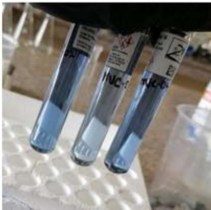
**Figura 36:** Formación de un color azul ante la presencia de fosfatos en la muestra de forraje.
