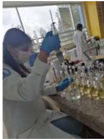
**Figura 35:** Mezcla de la muestra y reactivo HACH para la medición de fosfatos, nitratos, sulfatos
