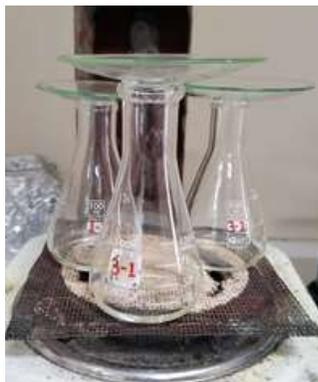
**Figura 60:** Digestión finalizada de muestras de leche para determinación de Pb, Cd, As, Hg y Se.
