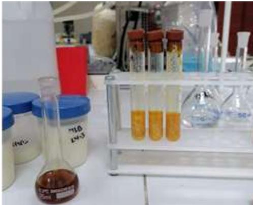
**Figura 58:** Adición de alizarol para identificación de neutralizantes.
