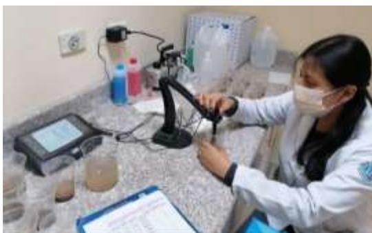
**Figura 15-2.** Medición de pH y CE en suelos
