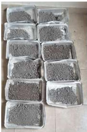
**Figura 11:** Secado de muestras de suelo a temperatura ambiente.
