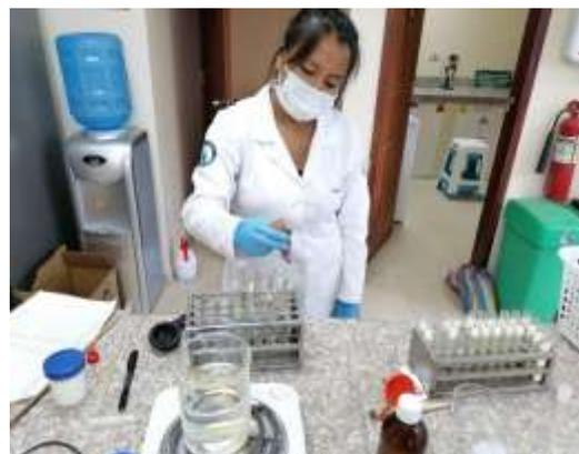
**Figura 55:** Adición de cloruro férrico para la identificación de formaldehído.
