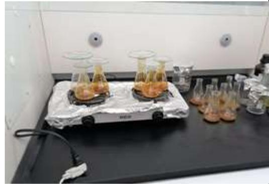
**Figura 47:** Digestión de muestras de forraje con  $\text{HNO}_3$
