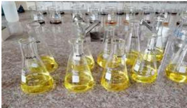
**Figura 40:** Muestras de forraje con  $K_2CrO_4$  para determinación de cloruros.
