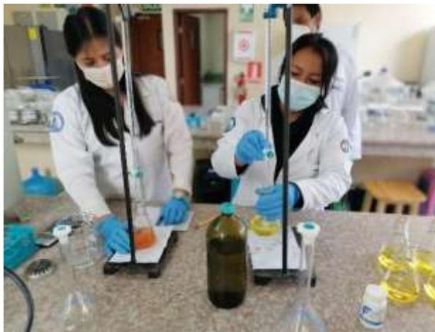
**Figura 25-2.** Medición de cloruros por el método argentométrico
