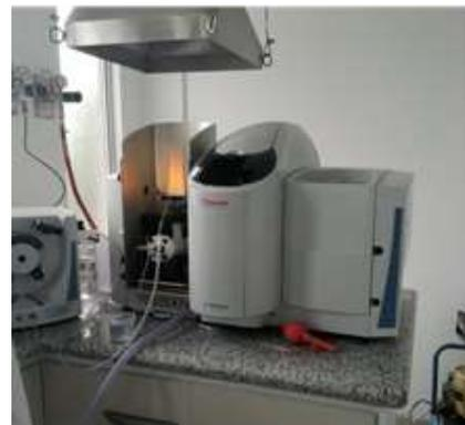
**Figura 49:** Determinación de Pb, Cd, As, Hg y Se en el espectrofotómetro de absorción atómica.
