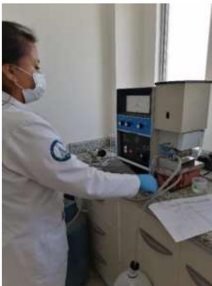
**Figura 27-2.** Medición de Na y K en el fotómetro de llama
