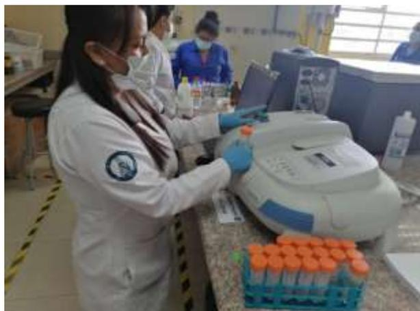
**Figura 28-2.** Medición de P en el espectrofotómetro UV-VIS
