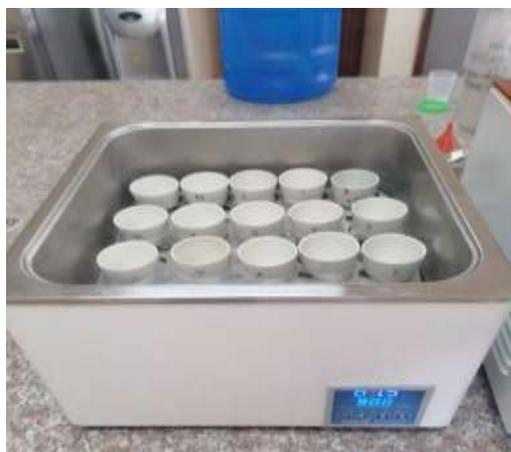
**Figura 32-2.** Determinación de cenizas.
