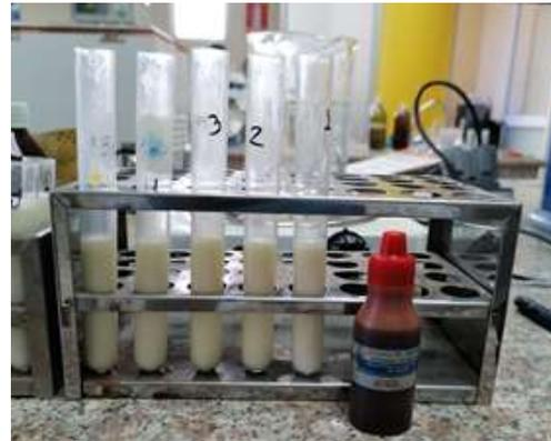
**Figura 59:** Adición de lugol para la detección de almidón.
