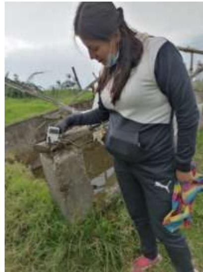
**Figura 8:** Determinación de temperatura y humedad con un termo higrómetro
