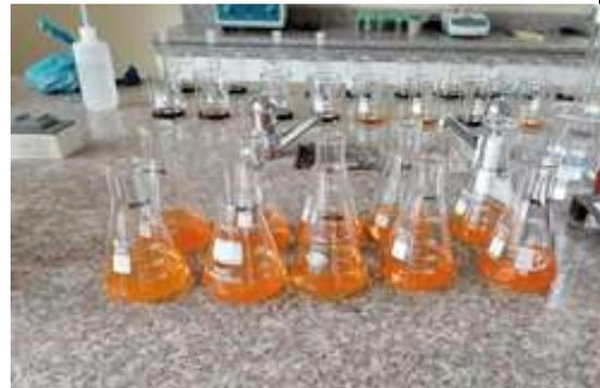
**Figura 41:** Muestras de forraje valoradas con  $AgNO_3$  para determinación de cloruros.
