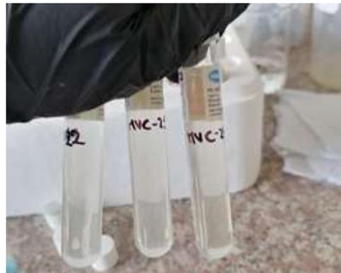
**Figura 37:** Formación de turbiedad en las muestras de forraje ante la presencia de sulfatos.
