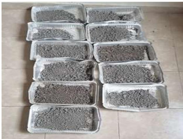
**Figura 6-2.** Secado de muestras de suelo a temperatura ambiente.
