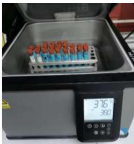
**Figura 33-2.** Ensayo de reductasa.
