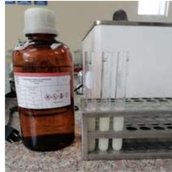
**Figura 57:** Adición de ácido acético para la identificación de cloro, hipocloritos y cloraminas en leche.
