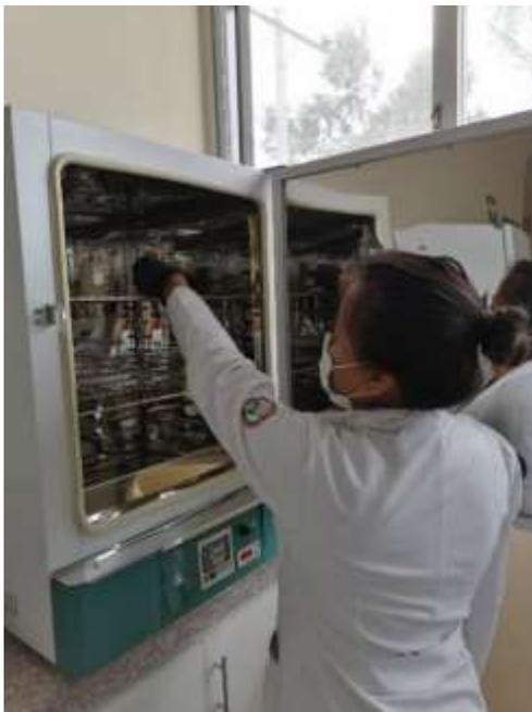
**Figura 15:** Secado a 105 °C del forraje molido para la realización de los diferentes análisis.
