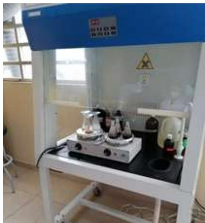
**Figura 42:** Digestión de forraje con  $H_2SO_4$  para determinación de Na, K y P.
