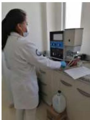
**Figura 25:** Digestión de suelo con  $H_2SO_4$  para determinación de K y P.
