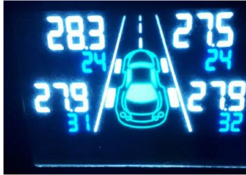
Figura 2-10: Toma de datos de presión y temperatura Realizado por: Lemache Wilmer, Sangoquiza Estalin, 2020
