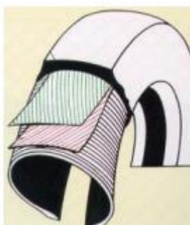
Figura 1-4: Neumático radial Fuente: (Afrisa, 2018)
