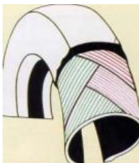
Figura 1-3: Neumático diagonal Fuente: (Afrisa, 2018)
