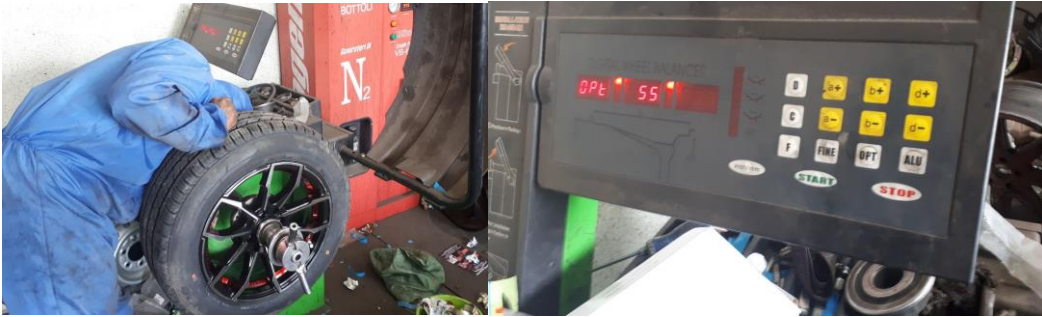
Figura 2-8: Proceso de balanceo de los neumáticos Realizado por: Lemache Wilmer, Sangoquiza Estalin, 2020
