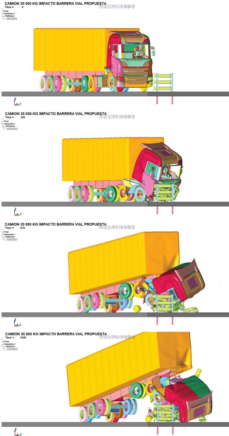
Gráfico 15.4 Impacto barrera vial propuesta ensayo TB71(SCANIA 30000 Kg, 65Km/h, ángulo 20°), medida de anchura de trabajo W = 3005 mm.
