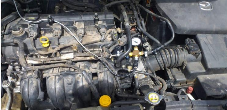
**Figura 21-3.** Conexión del prototipo al vehículo de pruebas
