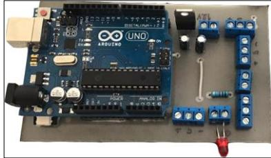
**Figura 10-3.** Placa electrónica de adquisición de datos en PCB.
