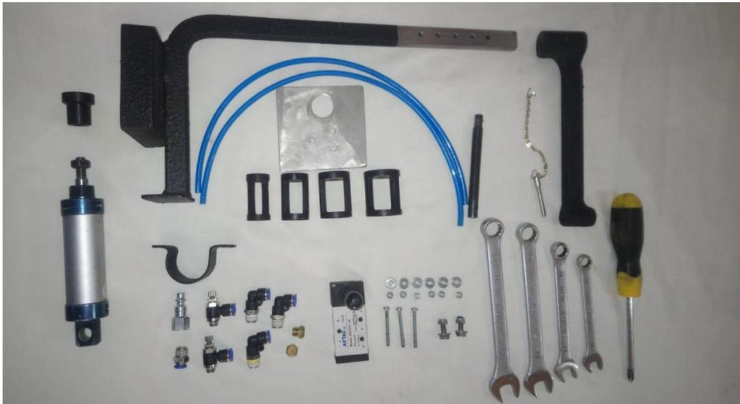
**Figura 27-3:** Elementos que componen el compresor de muelles neumático
