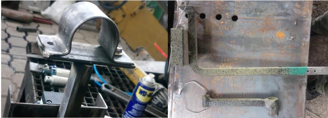
**Figura 26-3:** Superficies para el proceso de soldadura y posterior aplicación de pintura
