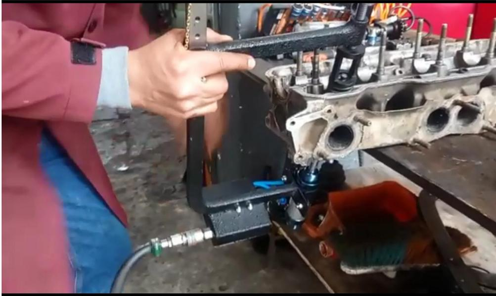
**Figura 28-3:** Utilización de la herramienta neumática en el desmontaje de válvulas
