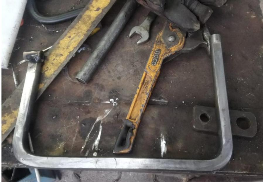
**Figura 22-3:** Doblado del eje mecanizado del marco principal
