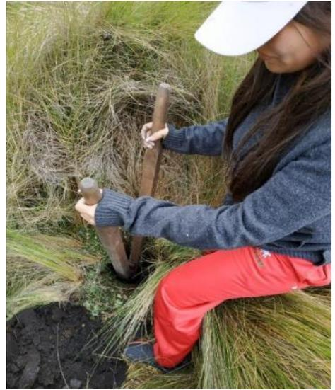
Utilización de la pala hoyadora para remover el exceso de suelo
