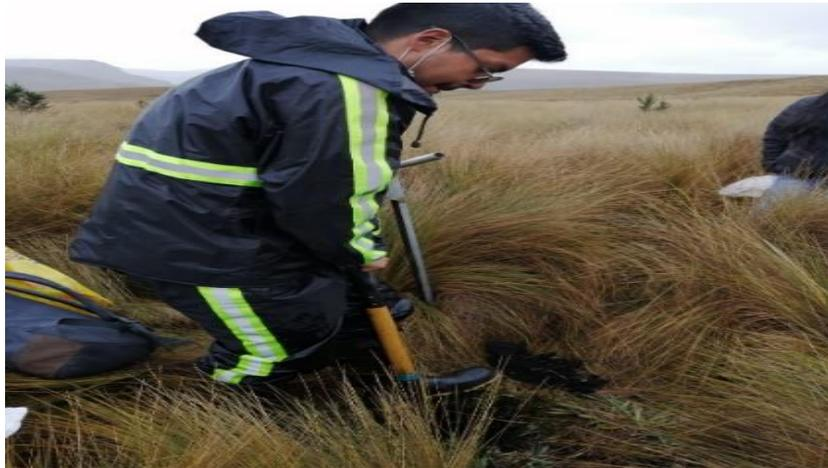
**Figura 1-2.** Perforación con el barreno y toma de muestras de suelo
