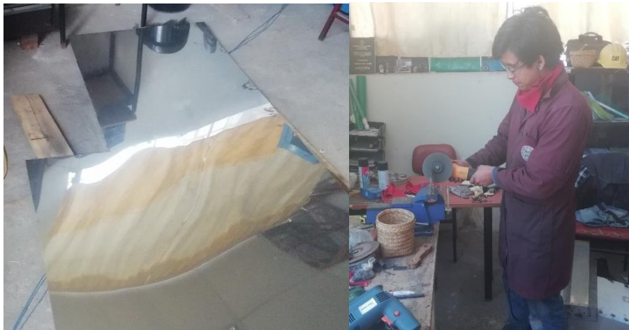
Figura 30-3. Corte de la plancha y barras para la zapata y mecanismo de movimiento de las zarandas.
