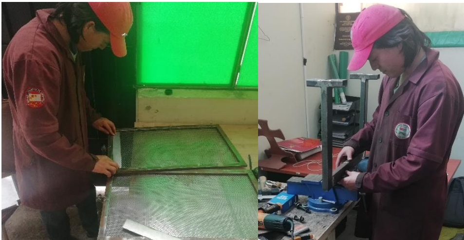
Figura 32-3. Construcción de las zarandas y soporte del mecanismo de las zarandas.
