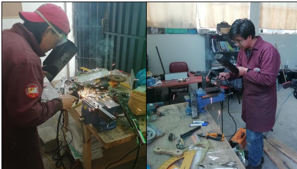
Figura 13-3. Soldadura de las platinas, eje de soporte y soporte del batidor.
