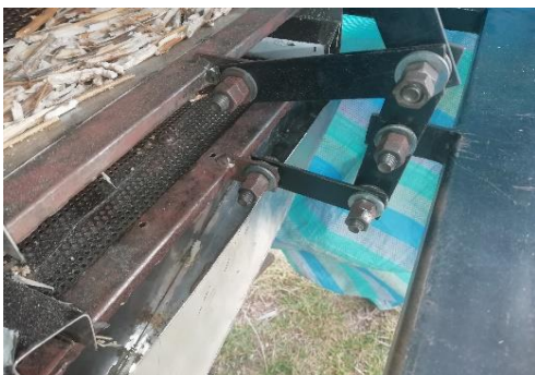
Figura 33-3. Instalación del mecanismo de movimiento de las zarandas.
