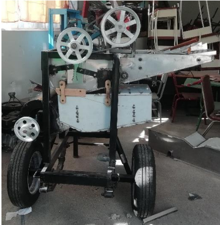
Figura 31-3. Montaje de la zapata de limpieza.
