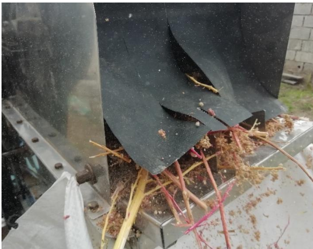
Figura 53-3. Lona permitiendo la expulsión del material una vez terminado el proceso de trilla.
