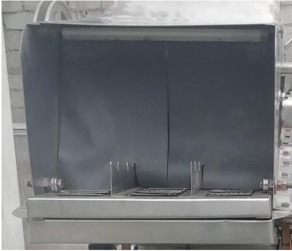
Figura 52-3. Lona en la parte final de la criba.
