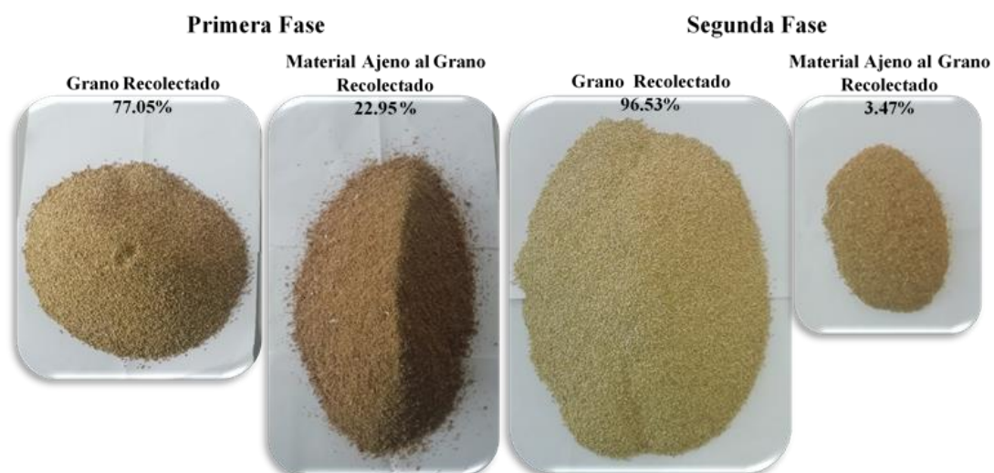
Gráfico 15-4. Grado de limpieza del grano del prototipo antes y después de su optimización.
