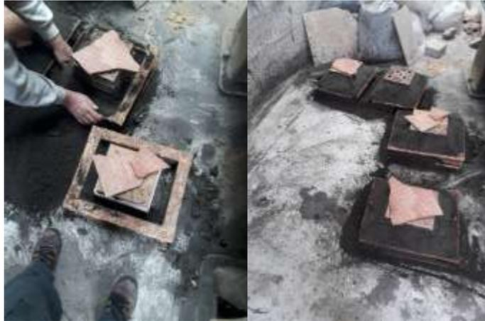
**Figura 86-3.** Rellenado de arena húmeda alrededor de los moldes
