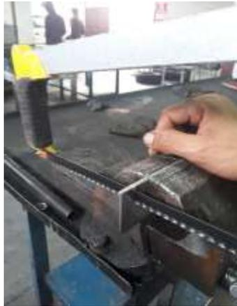
**Figura 9-3.** Corte de probeta para ensayos.
