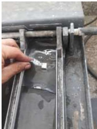
**Figura 10-3.** Pulido de probeta
