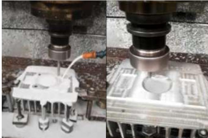
**Figura 105-3.** Mecanizado de cabezote
