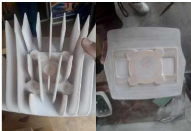
**Figura 62-3.** Lijado de superficie masillado en el molde
