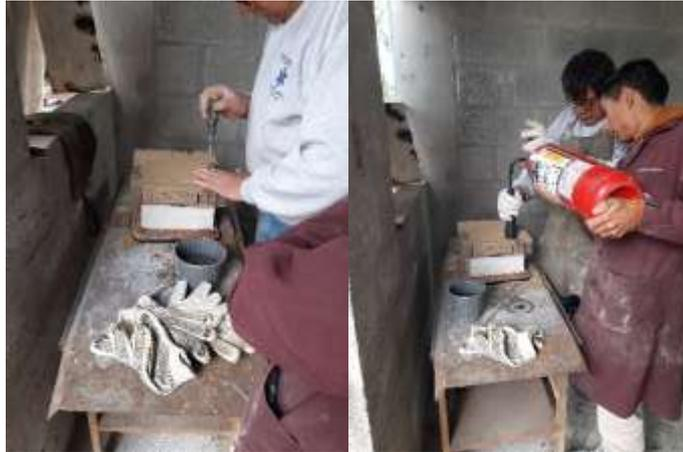
**Figura 75-3.** Perforaciones y aplicación de Dióxido de carbono
