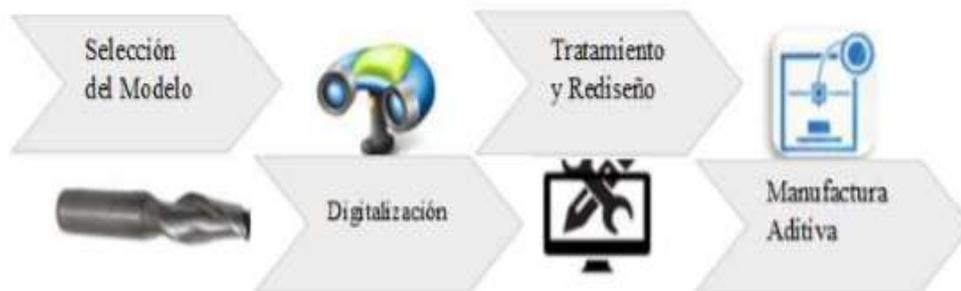
**Figura 6-2.** Ingeniería Inversa en el prototipado de elementos mecánicos
