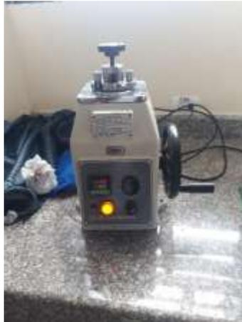
**Figura 11-3.** Maquina empastilladora de baquelita
