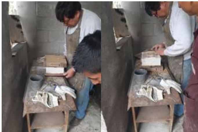
**Figura 76-3.** Verificación de endurecimiento del molde
