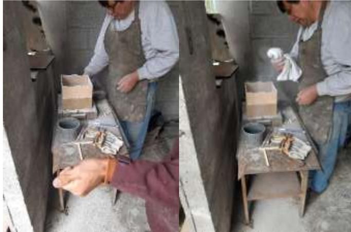
**Figura 79-3.** Colocación de tercera caja de molde
