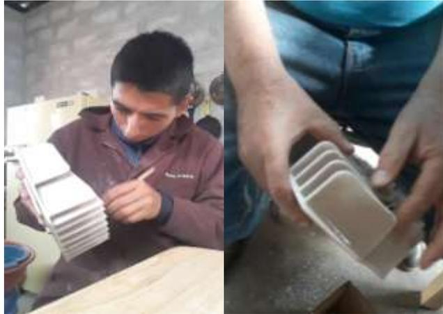
**Figura 65-3.** Inserción de Diesel en la superficie del molde
