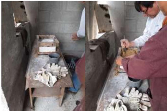
**Figura 74-3.** Llenado de la segunda caja del molde de arena
