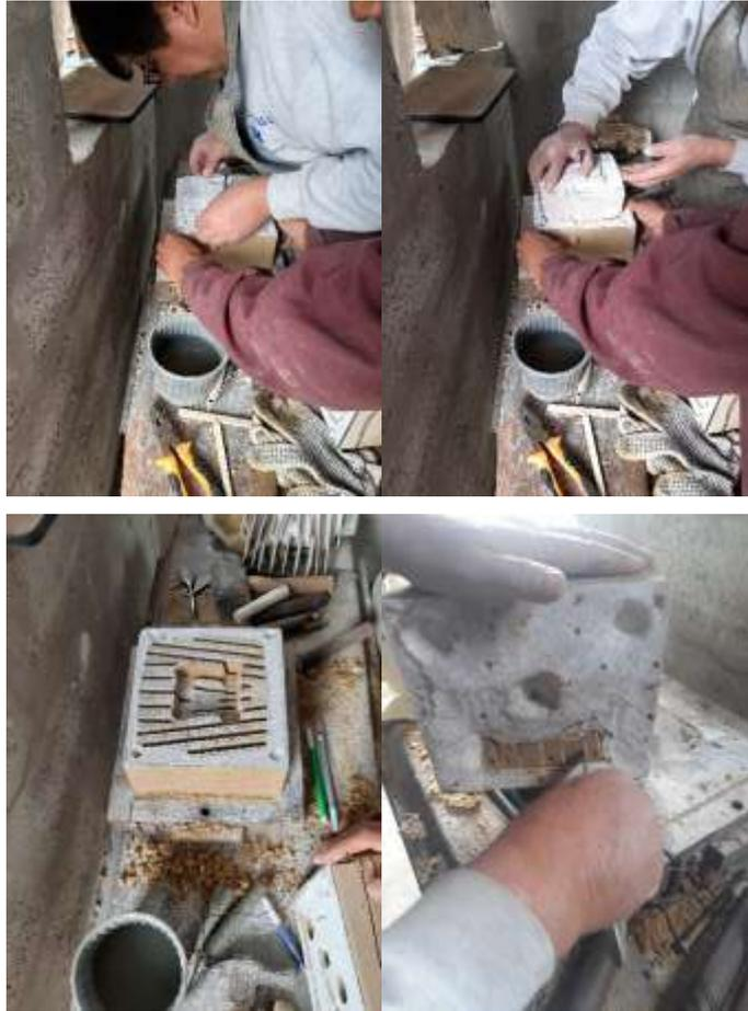
**Figura 83-3.** Verificación de los moldes de arena
