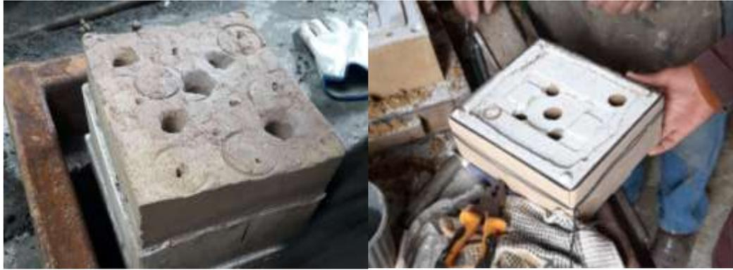
**Figura 60-3.** Bebederos de molde de fundición.
