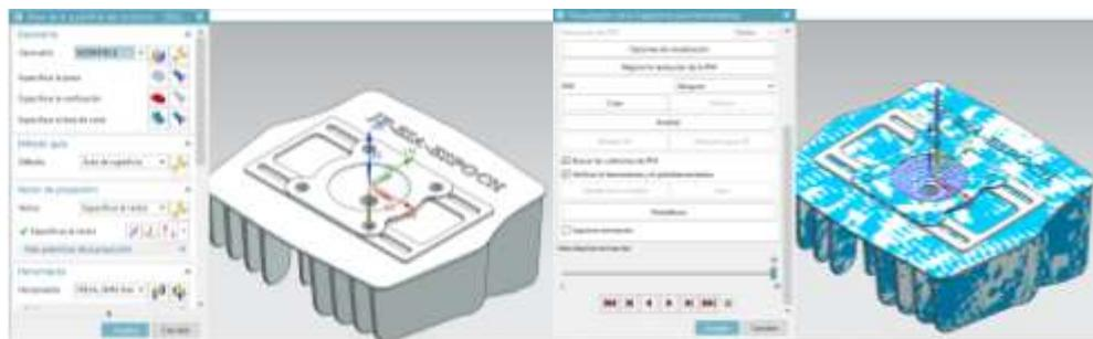
**Figura 47-3.** Segunda pasada en la cámara de combustión y verificación
