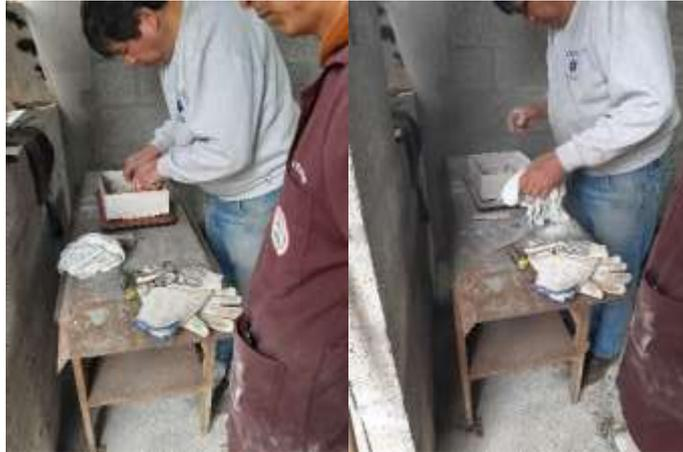
**Figura 69-3.** Colocación de caja y molde de cabezote
