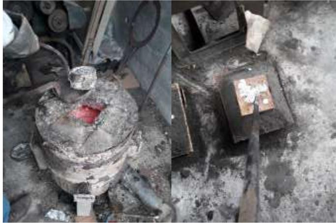
**Figura 95-3.** Colado del aluminio en los moldes de arena
