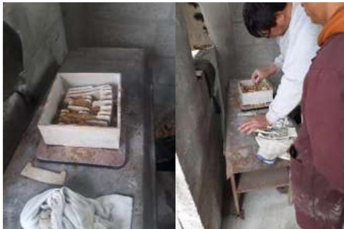
**Figura 70-3.** Llenado de arena preparada en la caja del molde
