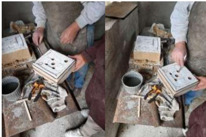
**Figura 82-3.** Comprobación de ultimo molde y separación
