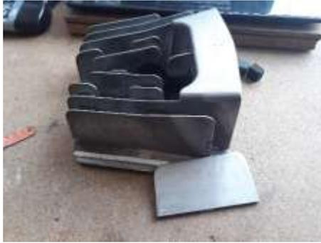
**Figura 8-3.** Corte de aleta del cabezote
