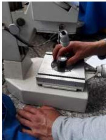
**Figura 28-3.** Medición de la huella del indentador
