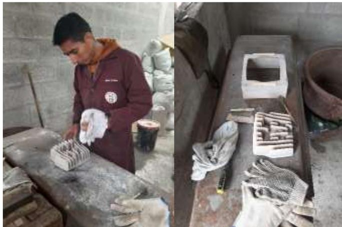
**Figura 66-3.** Aplicación de separador en el molde
