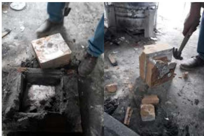
**Figura 97-3.** Quitado de moldes de arena mediante fractura con martillo
