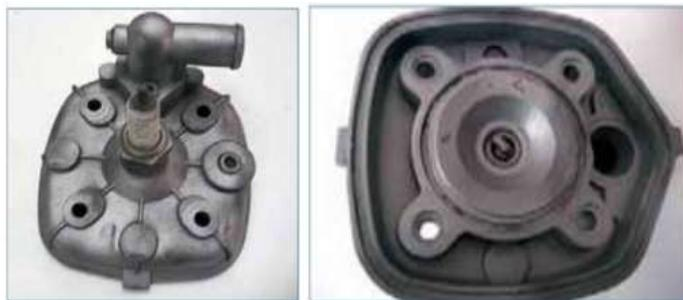
**Figura 3-2.** Culata refrigerada por líquido parte exterior e interior
