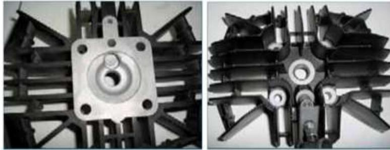
**Figura 4-2.** Culata refrigerada por aire parte exterior e interior
