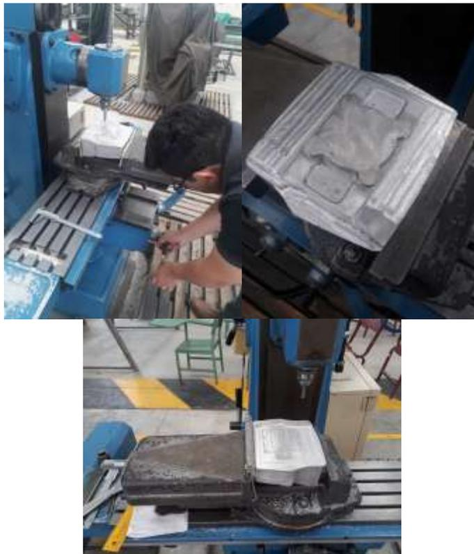
**Figura 101-3.** Colocación y fresado de parte inferior del cabezote
