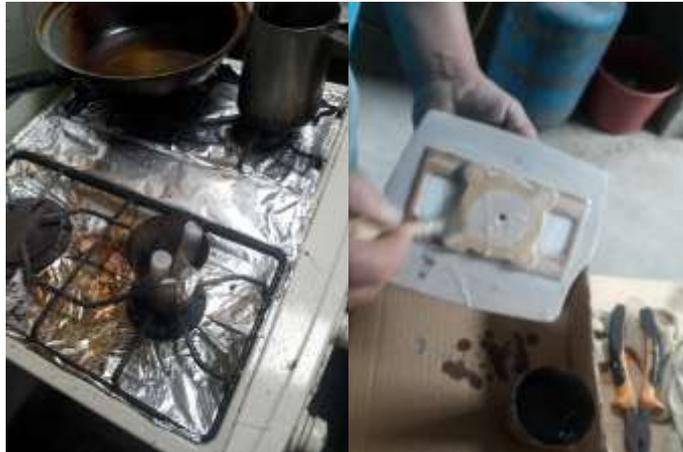
**Figura 63-3.** Preparación de cera y encerado del molde
