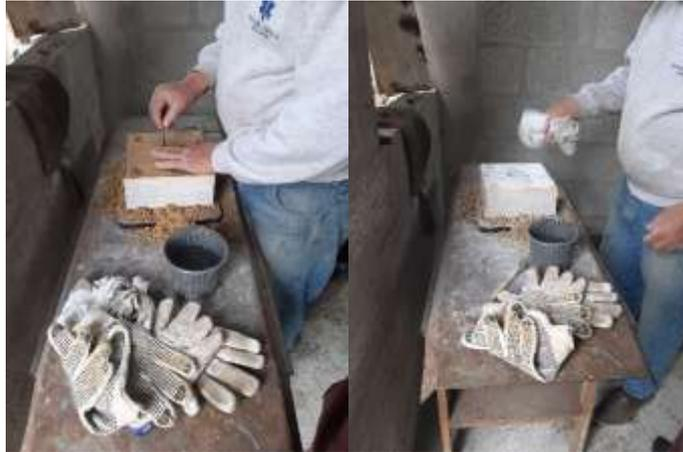
**Figura 73-3.** Realización de perforaciones y aplicación de separador
