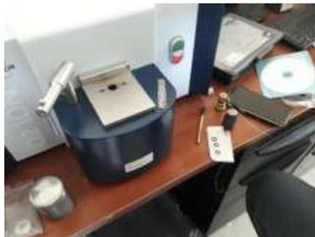
**Figura 23-3.** Limpieza y calibración del espectrómetro
