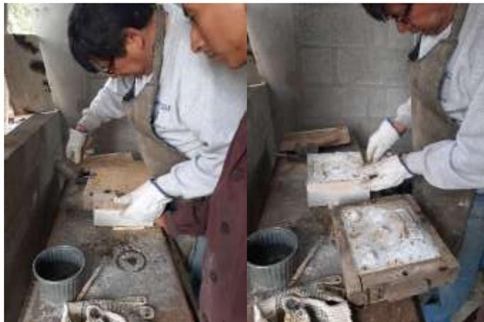
**Figura 78-3.** Separación de los moldes de arena
