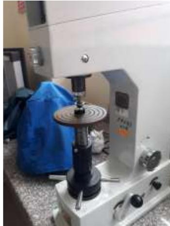
**Figura 27-3.** Ensayo de dureza Brinell
