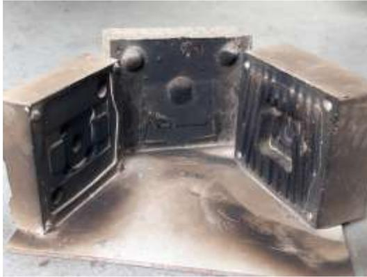
**Figura 84-3.** Secado de moldes de arena mediante soplete a gas
