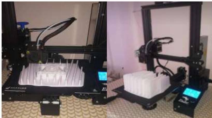
**Figura 38-3.** Impresión 3D del cabezote
