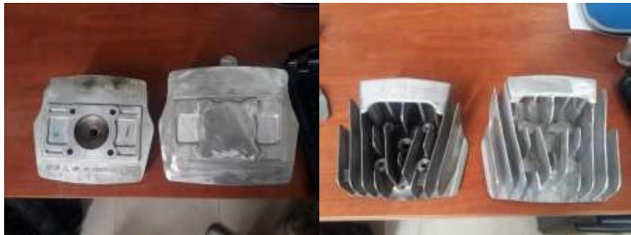
**Figura 99-3.** Comparación del cabezote fundido con el cabezote original
