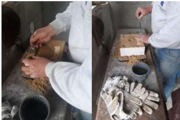
**Figura 72-3.** Realización de hendiduras en el molde de arena
