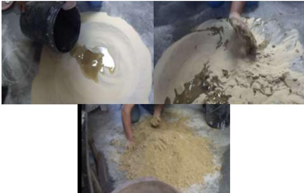
**Figura 68-3.** Preparación de arena para moldear con silicato de calcio
