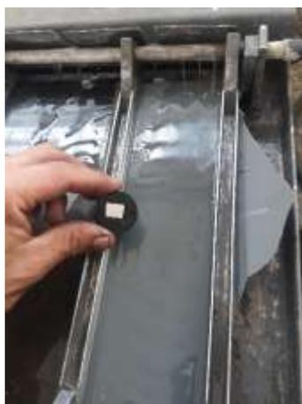
**Figura 14-3.** Pulido final de probeta empastillada
