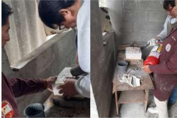
**Figura 77-3.** Aplicación de dióxido de carbono al primer molde
