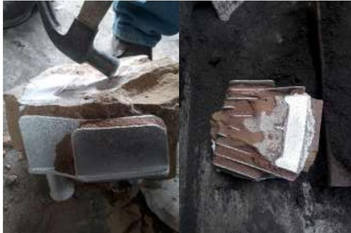
**Figura 98-3.** Quitado de arena en partes interiores del cabezote
