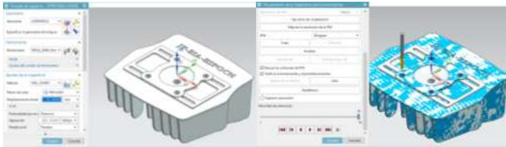
**Figura 49-3.** Perforación de orificios de sujeción de pernos y verificación
