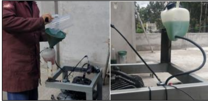
Figura 32-2: Colocación de la mezcla en el tanque de combustible
