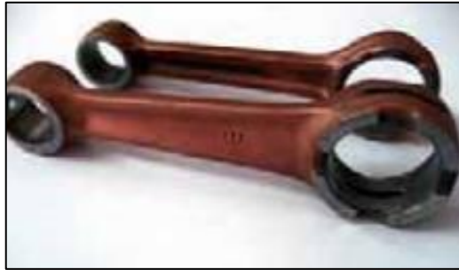
Figura 5-1: Tipos de bielas en un motor de dos tiempos
