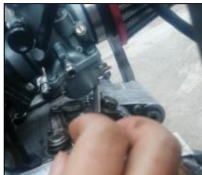
Figura 31-2: Vaciado de combustible por la cuba del carburador
