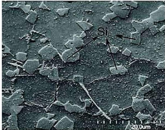
Figura 4-2: Silicio primario formado por vibración ultrasónica
