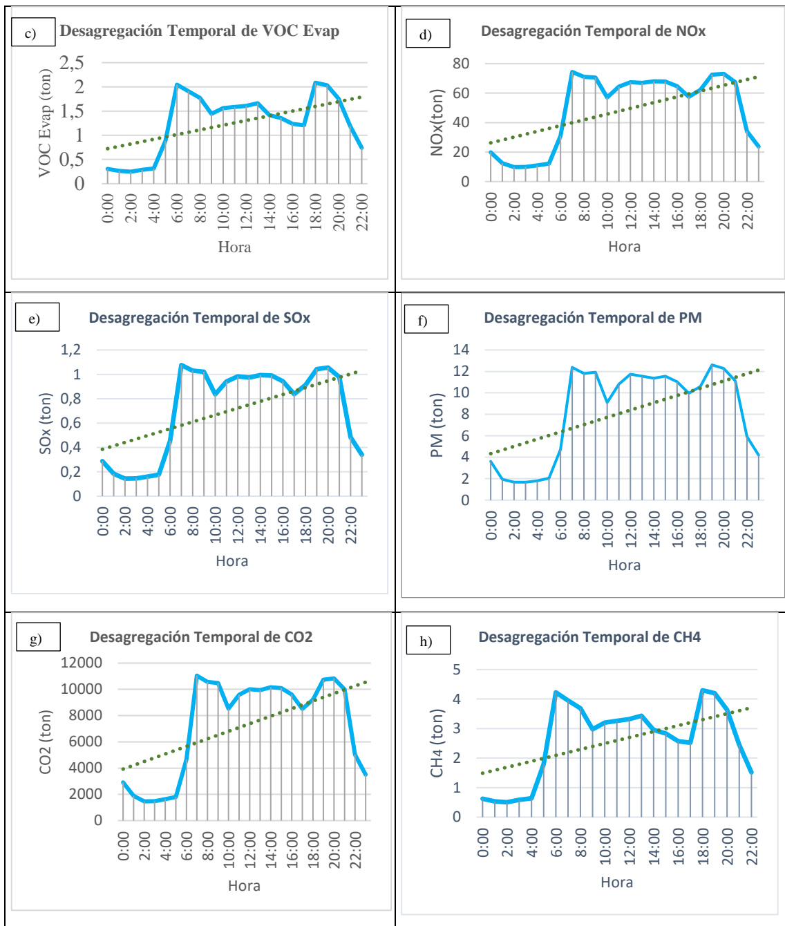
Figura 15-3: Desagregación temporal de: a) CO, b) VOC, c) VOCEvap, d) NOx, e) SOx, f) PM, g) CO 2 , h) CH 4
