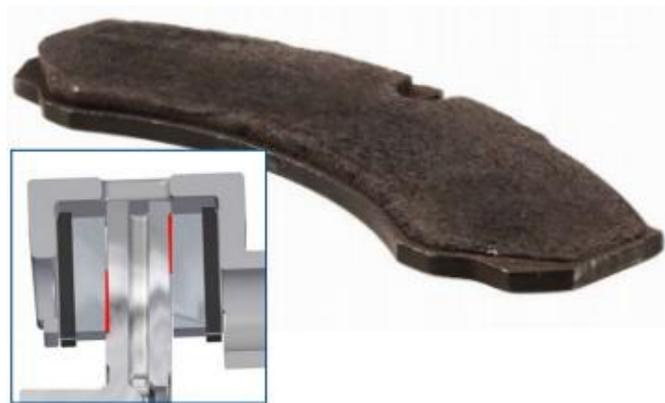
**Figura 20-1:** Desgaste asimétrico de las pastillas
