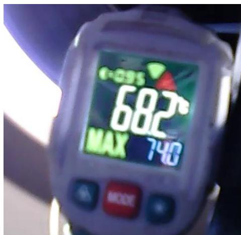
**Figura 5-3:** Temperatura inicial de frenado
