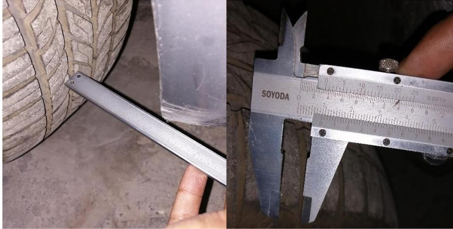
**Figura 4-3:** Profundidad de labrado del neumático
