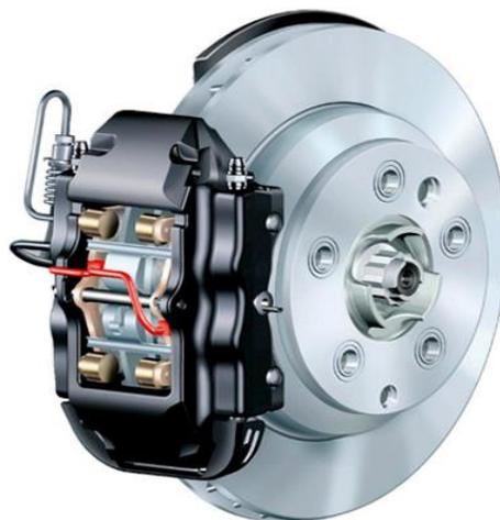
**Figura 5-1:** Sistema de freno de disco
