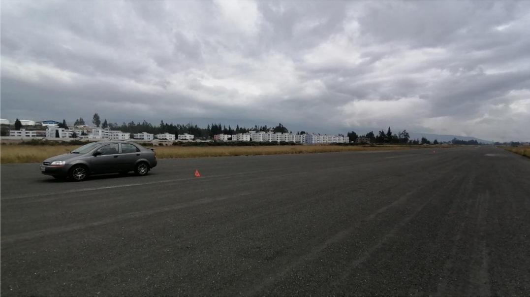
**Medición de la distancia de frenado a 50 km/h**
