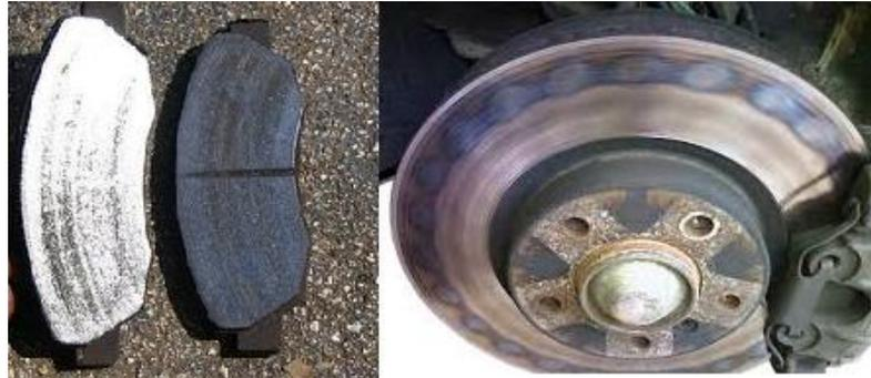
**Figura 19-1:** Cristalización de las pastillas de frenos
