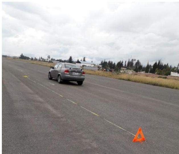
**Figura 7-3:** Distancia de frenado a 50 km/h
