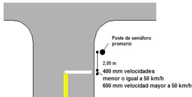
**Figura 8-1:** Línea de pare en intersecciones semaforizadas
