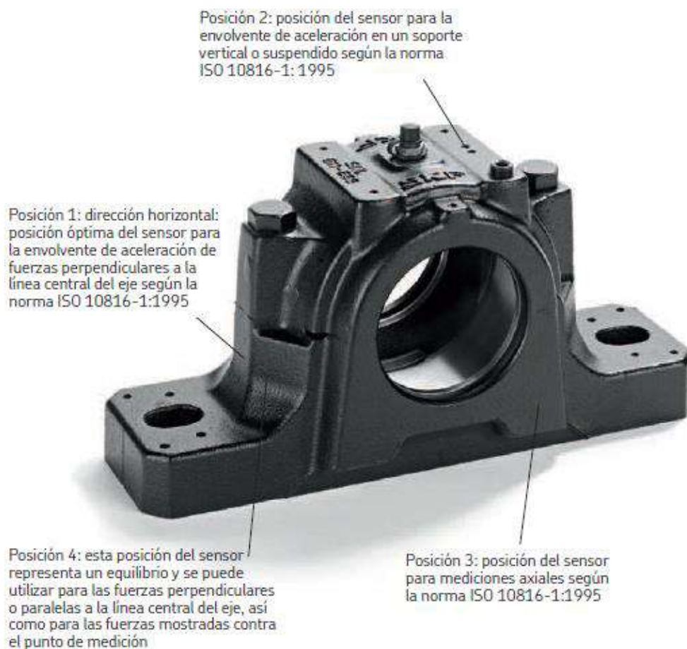
Figura 12-3. Puntos de medición para la monitorización de la condición
