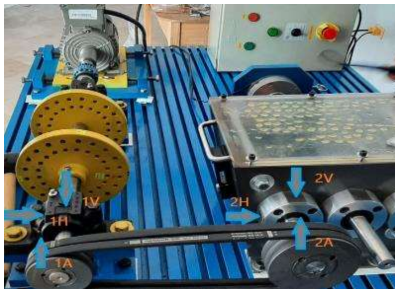
Figura 2: Puntos de medición para vibración.
