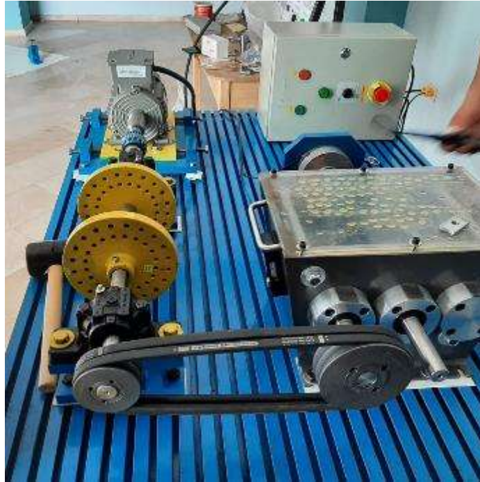
Figura 2-4. Banco de pruebas para el diagnóstico de fallas.
