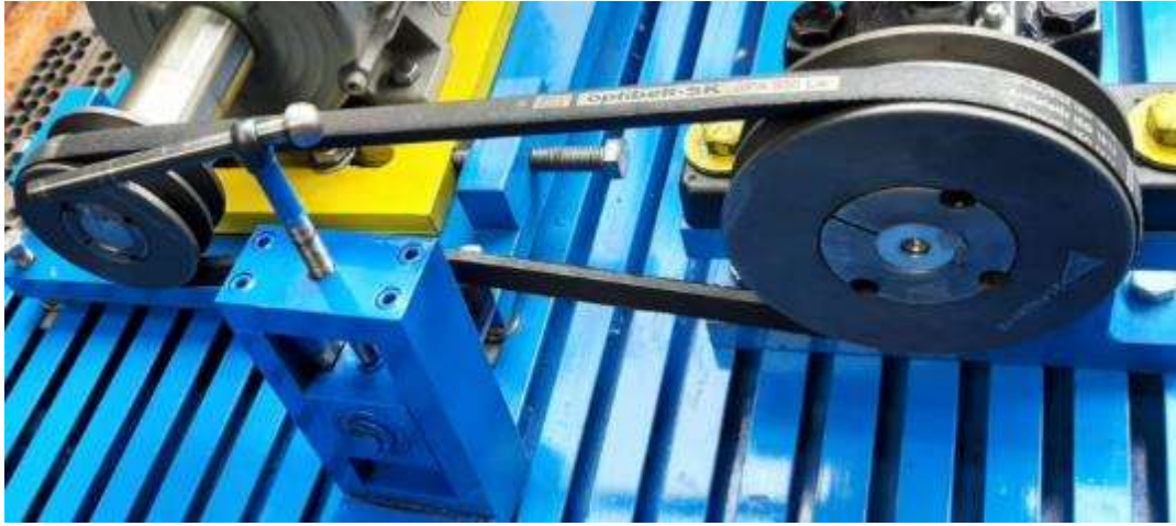
Figura 59-3. Sistema de sujeción montado.
