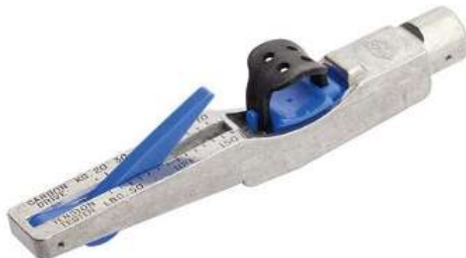
Figura 15-3. Equipo medidor de tensión de la banda, marca: Optibelt.
