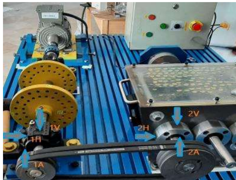
Figura 4: Puntos de medición para vibración.
