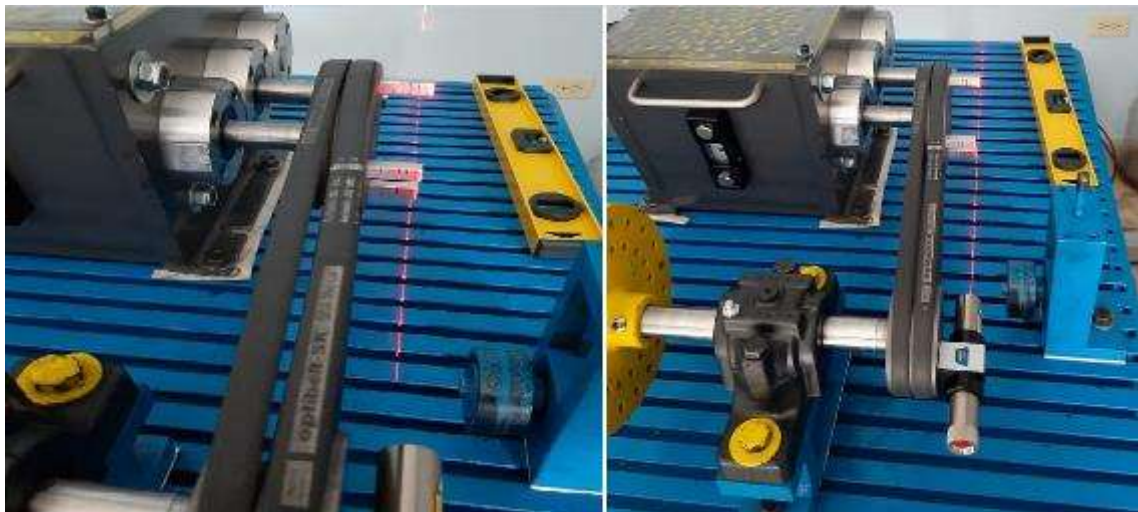
Figura 5-4. Poleas desalineadas para el análisis de espectros de vibración.
