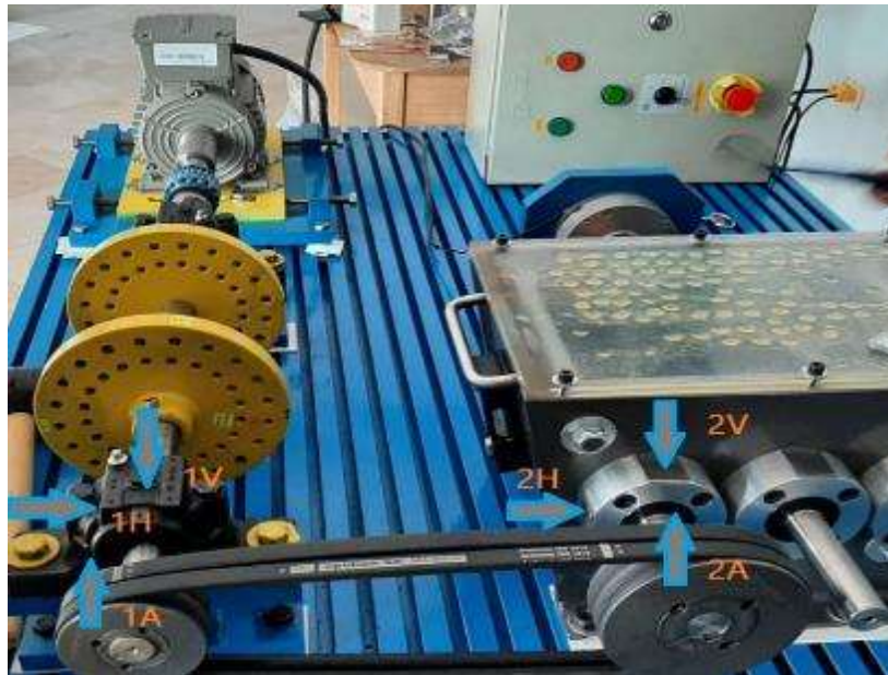
Figura 6-4. Ubicación de los puntos de medición en el banco de pruebas.
