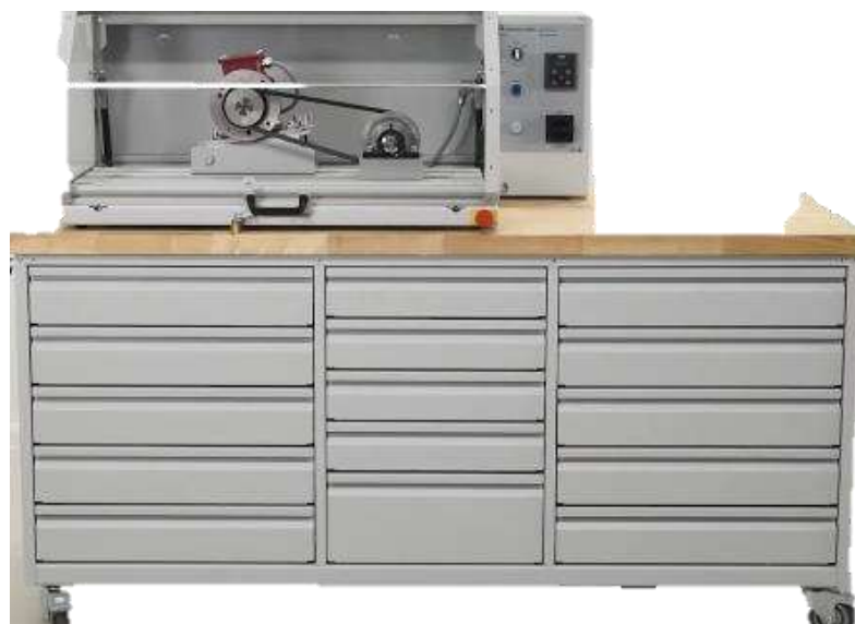
Figura 1-3. Sistema de aprendizaje de transmisiones mecánicas: transmisiones por banda.
