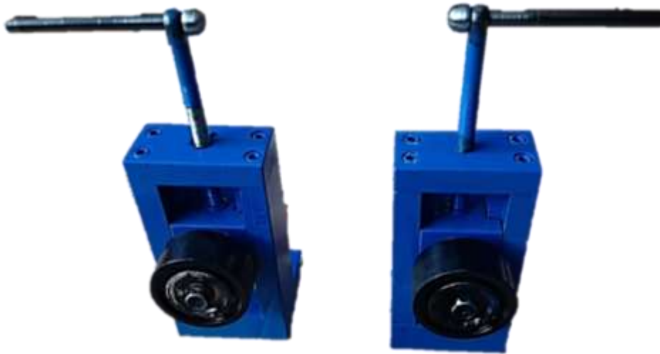
Figura 54-3. Sistema tensionador construido.
