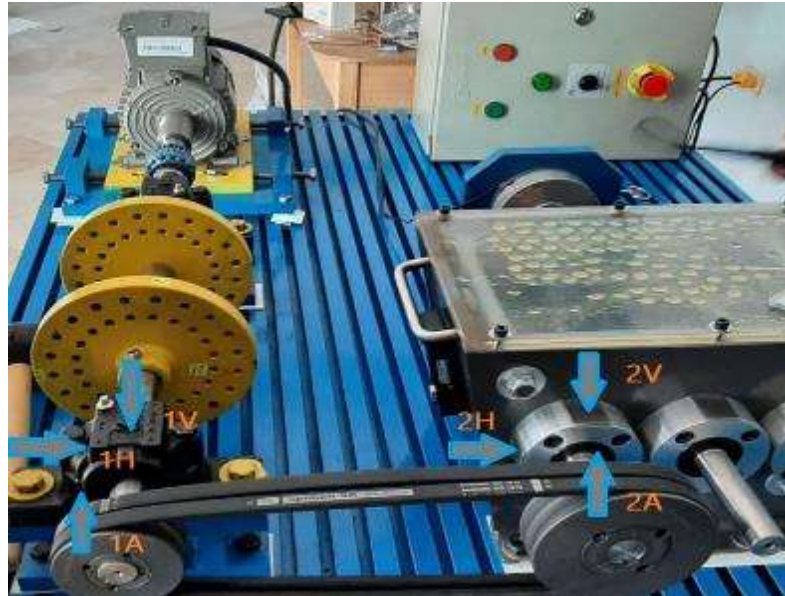
Figura 4: Puntos de medición para vibración.
