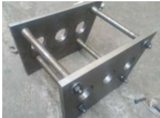
Figura 19-3. Planchas frontales terminadas y tensores
