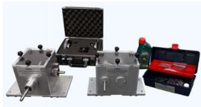
Figura 1-3. Set de defectos en engranajes
