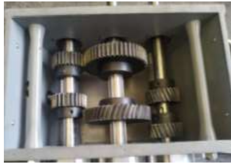
Figura 25-3. Ensamble de engranes, ejes y bridas
