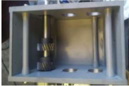
Figura 24-3. Montaje de los ejes con los engranes
