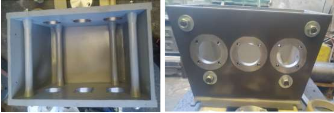
Figura 20-3. Armado final y pintado de la coraza
