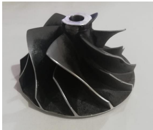
Figura 29-3: Impeller core cartridge para Chevrolet LUV 2.2/2.5
