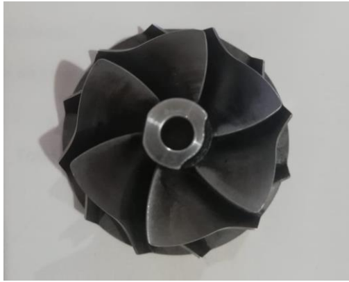
Figura 30-3: Vista superior del Impeller core cartridge para Chevrolet LUV 2.2/2.5
