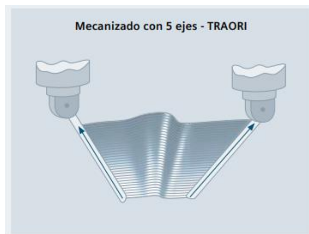
Figura 28-3: Mecanizado CNC de 5 ejes mediante TRAORI
