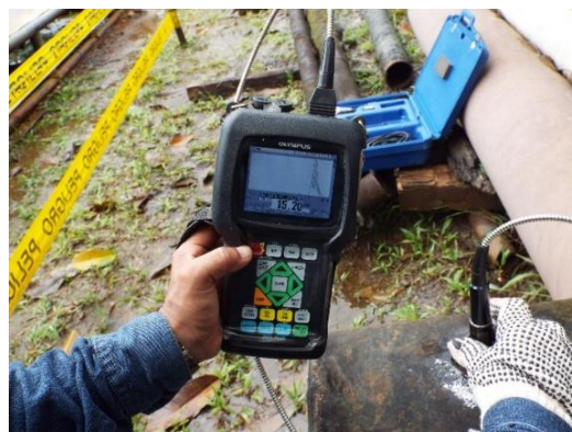
Figura 10-2: Verificación del espesor mediante UT.
