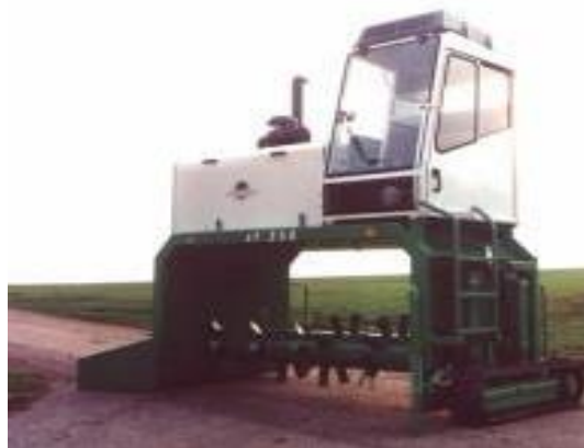
Figura 9-2. Volteadora de compost sistema autopropulsado.
