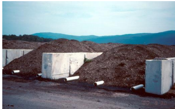
Figura 3-2. Detalle de pilas estáticas con aireación natural.
