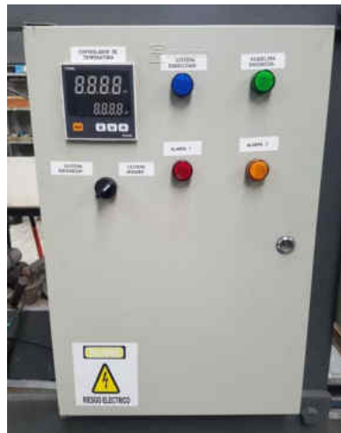
Figura 32-2: Tablero de control del sistema de temperatura.
