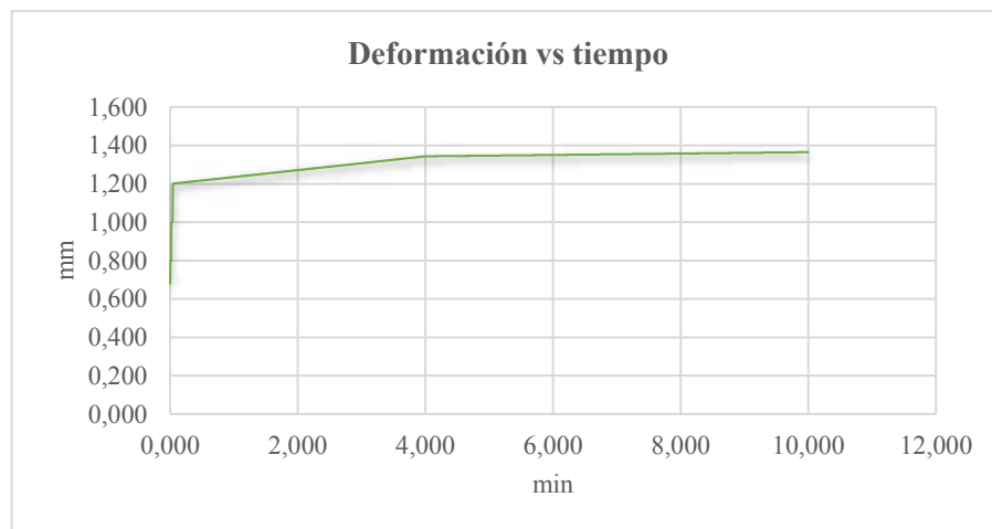
Figura 17-3: Curva 2 Deformación vs Tiempo del acero ASTM A36 a 500°C.
