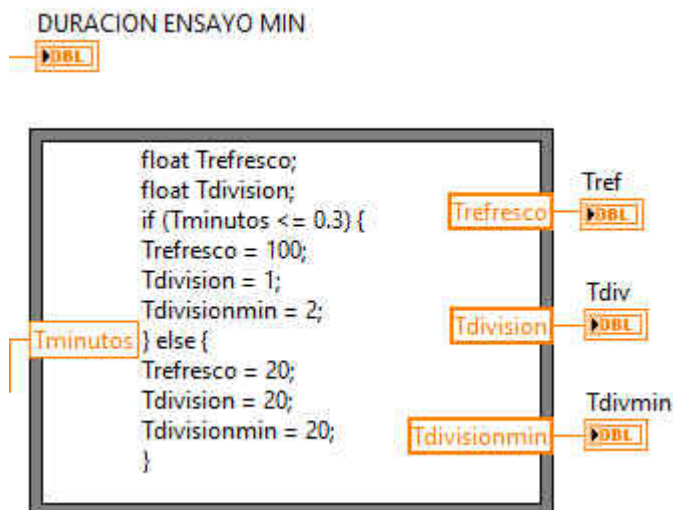
Figura 57-2: Programación calculo tiempo de ensayo en minutos.
