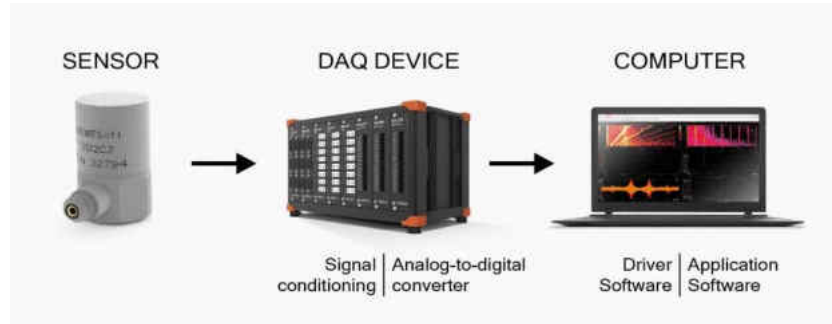
Figura 1-2: Elementos de un sistema moderno de adquisición de datos.
