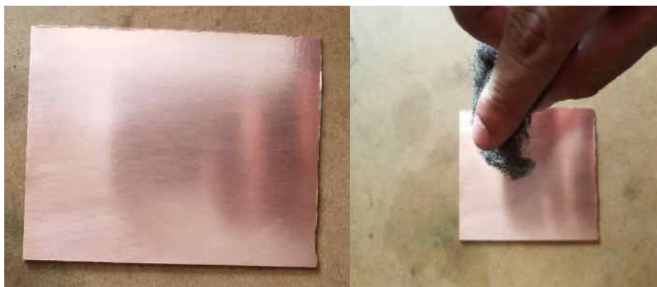
Figura 25-2: Corte y limpieza de la placa.
