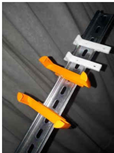
Figura 33-2: Bases de sujeción impresas en 3D.
