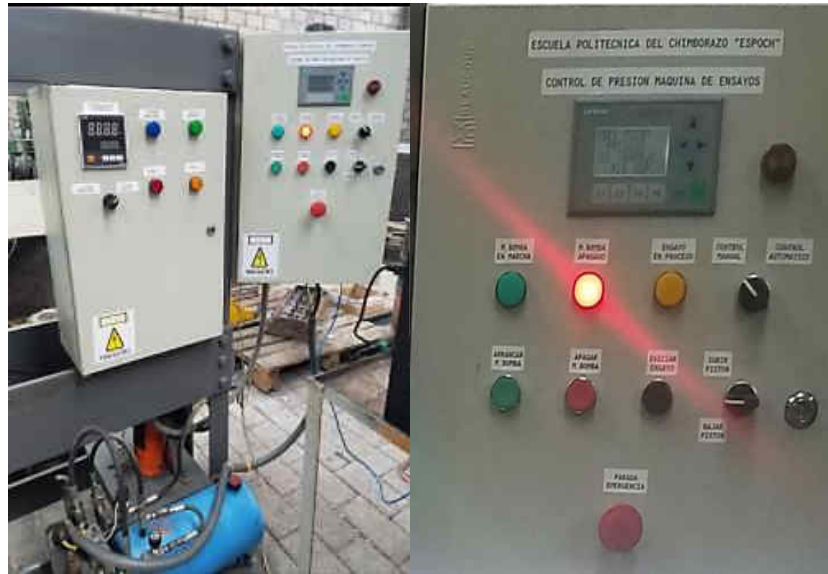
Figura 4-3: Seteo de la presión de ensayo en el controlador.
