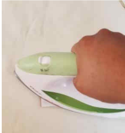
Figura 26-2: Transferencia del diseño a la placa.
