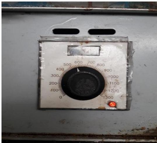
**Figura 5-2.** Selección de la temperatura de sinterización en el horno de mufla.
