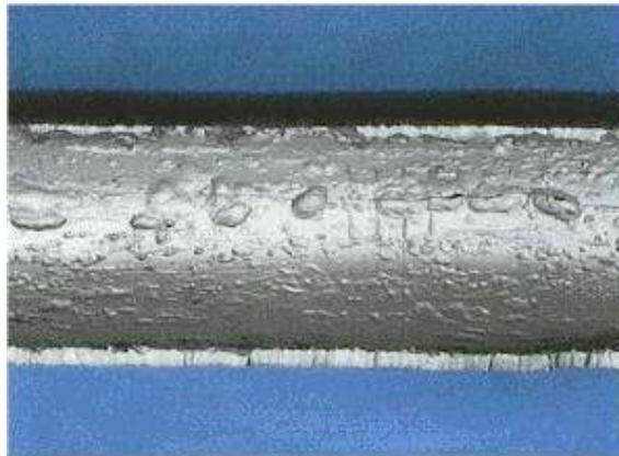
**Figura 27-1:** Corrosión por H<sub>2</sub>S.
