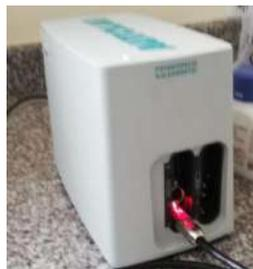
**Figura 6-2:** Potencioestato/Galvanostato PGSTAT 204.
