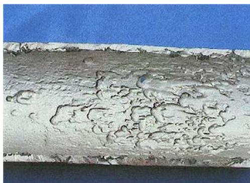
**Figura 26-1:** Corrosión causada por CO<sub>2</sub>
