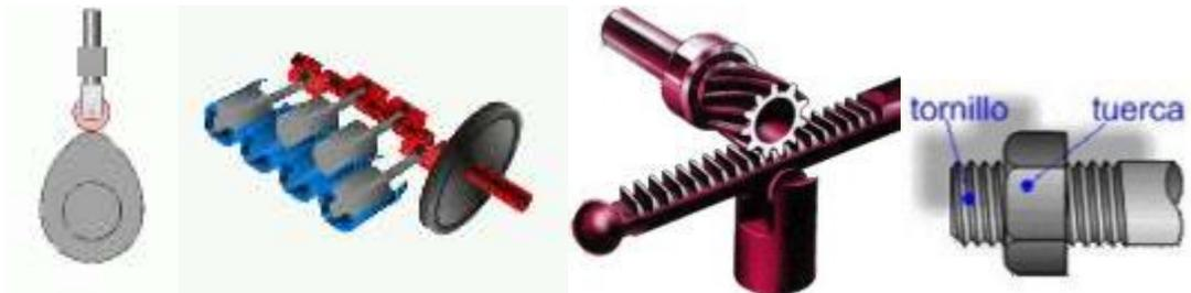
**Figura 12-3:** Mecanismos: Leva, Biela-Manivela, Piñón-Cremallera, Tornillo-Tuerca.
