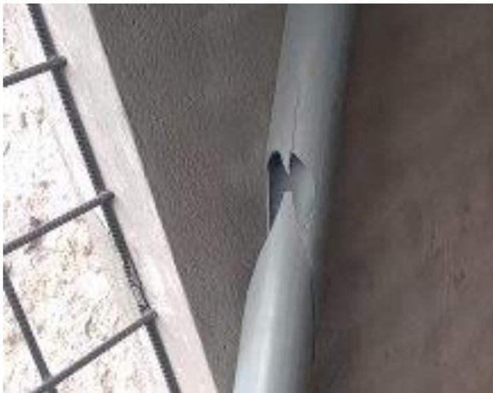
**Figura 24- 2:** Tubería fracturada producida por sobrepresión
