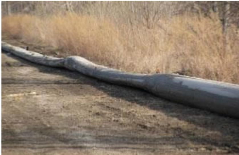
**Figura 25- 2:** Representación de una tubería deformada por depresión
