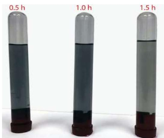
**Figura 1-3.** Imagen de rGO en suspensión en tres lapsos de centrifugación 0.5, 1 y 1.5 horas.
