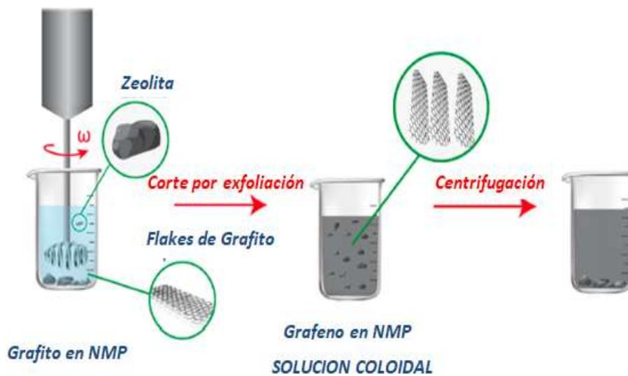
**Figura 3-3.** Ruta esquemática del proceso de exfoliación de grafito en NMP.
