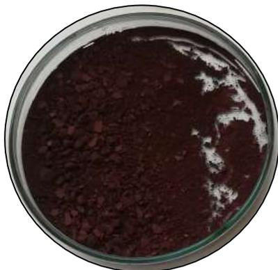
**Figura 14-3:** Nanopartículas de cobre método químico.
