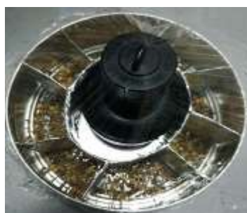
Figura 8-2. Cámara de iones electrete (E-PERM) y fuente de Uranio-238
