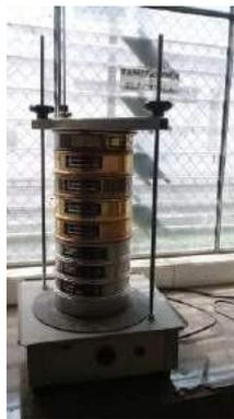
**Imagen 3.-** Colocar el suelo sobre los tamices y llevar a la tamizadora durante 10 a 15 Minutos
