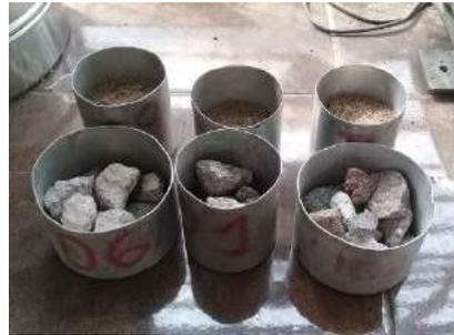
**Imagen 2.-** Colocar la muestra de suelo húmedo en los recipientes
