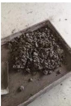
**Imagen 3.-** Verter el hormigón en una bandeja previamente humedecida
