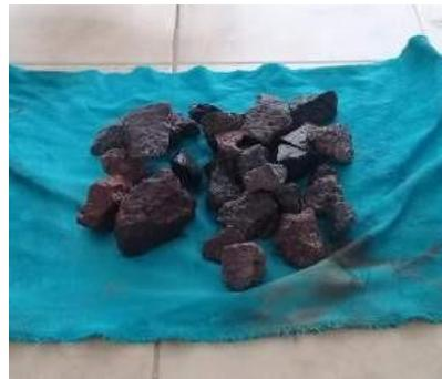
**Imagen 2.-** Secar el exceso de agua con ayuda de una franela
