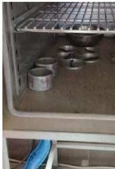
**Imagen 9.-** Tomar dos muestras de arena en estado SSS y colocar en el horno durante 24 horas
