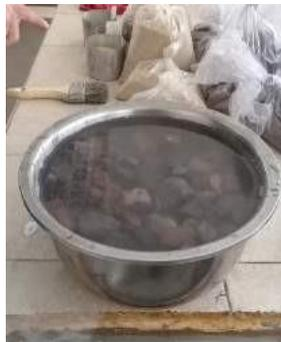
**Imagen 1.-** Sumergir el ripio en agua 24 horas antes del ensayo
