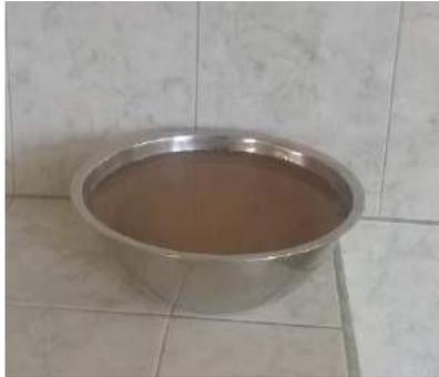
**Imagen 1.-** Sumergir la muestra de arena 24 horas antes del ensayo
