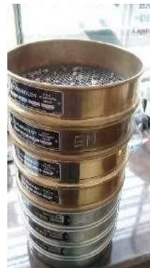
**Imagen 4.-** Sacar la muestra de la tamizadora
