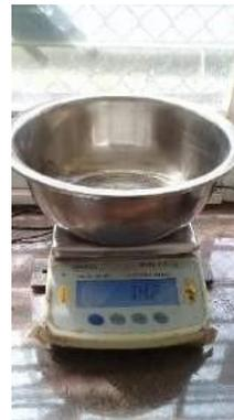
**Imagen 6.-** Pesar el material retenido en la fuente
