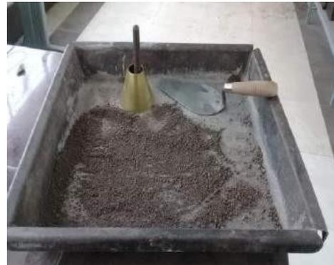
**Imagen 4.-** Verificar que el material alcanzó la condición de Saturado Superficie Seca (SSS), mediante el ensayo del cono y el pisón
