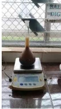
**Imagen 7.-** Llenar el picnómetro hasta la marca de aforo, extraer el aire ocluido y pesar el conjunto picnómetro más agua más arena
