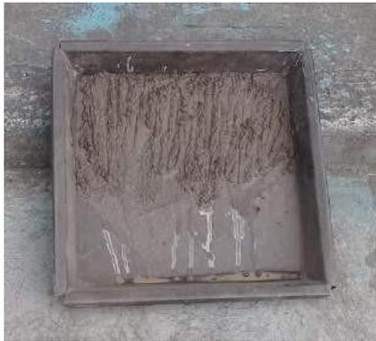
**Imagen 3.-** Colocar sobre una bandeja inclinada para que el agua empiece a escurrir
