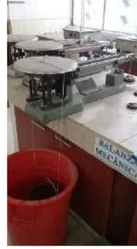
**Imagen 4.-** Pesar la canastilla sumergida en el agua
