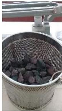
**Imagen 5.-** Colocar el suelo en estado SSS en la canastilla
