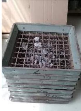
**Imagen 3.-** Colocar la muestra de suelo sobre los tamices
