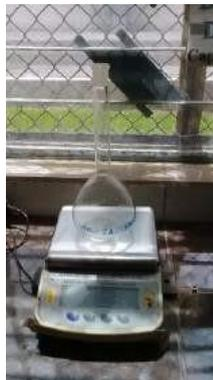
**Imagen 5.-** Pesar el picnómetro vacío
