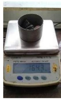
**Imagen 8.-** Determinar la capacidad de absorción tomando dos muestras de grava en condición SSS; pesar y colocar en el horno durante 24 horas. Finalmente pesar las muestras secas.
