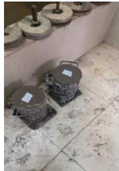
**Imagen 4.-** Colocar la mezcla en los moldes
