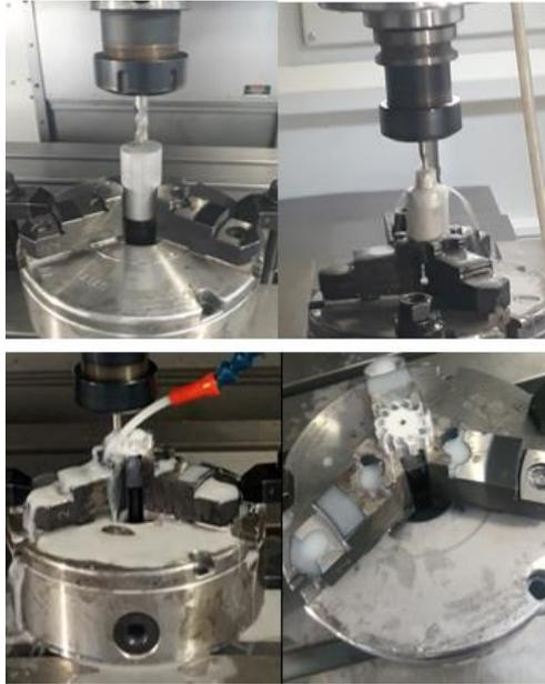
**Figura 11-4.** Mecanizado de la turbina.
