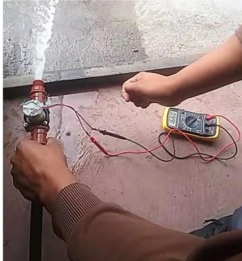
**Figura 27-4.** Prueba microturbina
