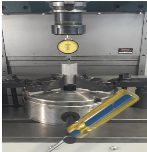
**Figura 10-4.** Calibración lingote de duraluminio
