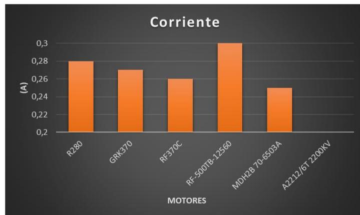
**Gráfico 2-4.** Comparación de la corriente entre los motores.
