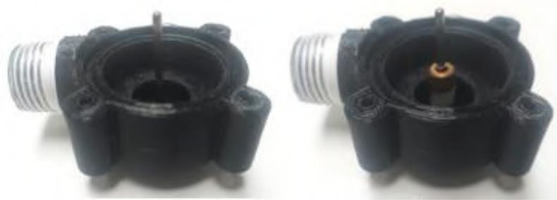
**Figura 22-4.** Colocación de eje y bujes
