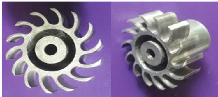
**Figura 12-4.** Microturbina hidráulica.
