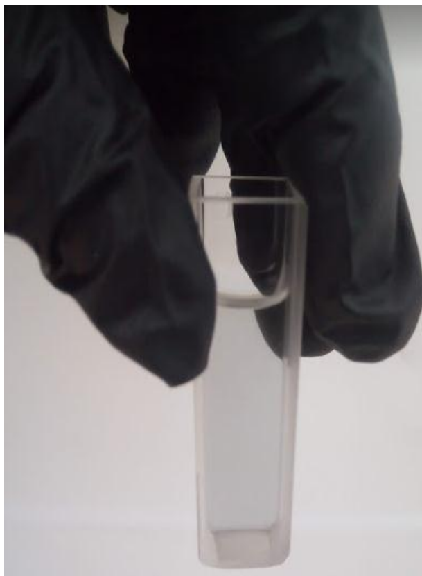
Figura 2D: Celda de cuarzo con 3 ml de suspensión de grafeno en etanol.
