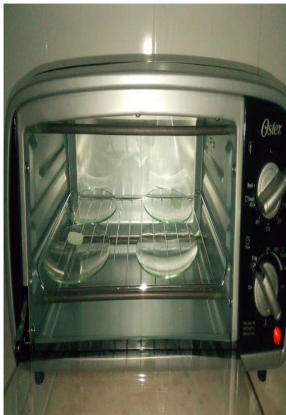
Figura 2F: Vidrios reloj colocados dentro del horno.
