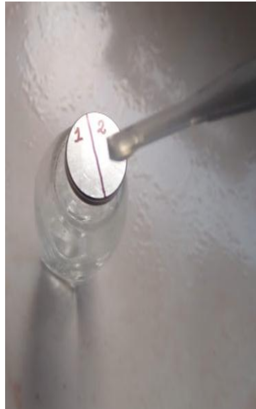
Figura 2I: Staff de aluminio con muestras para al análisis al SEM.
