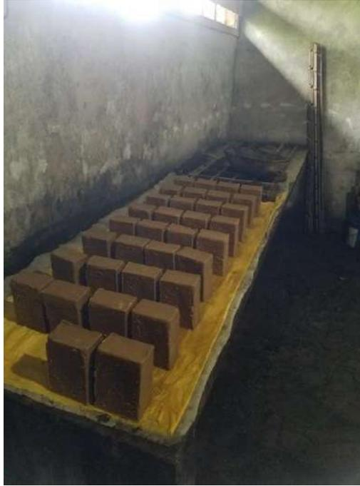
**Figura 16-4:** Enfriamiento de los bloques de panela sólida
