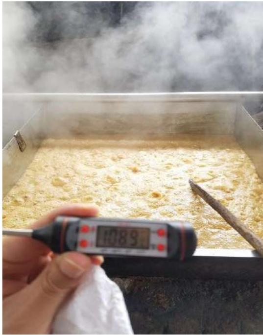
**Figura 9-4:** Temperatura de extracción de miel de caña
