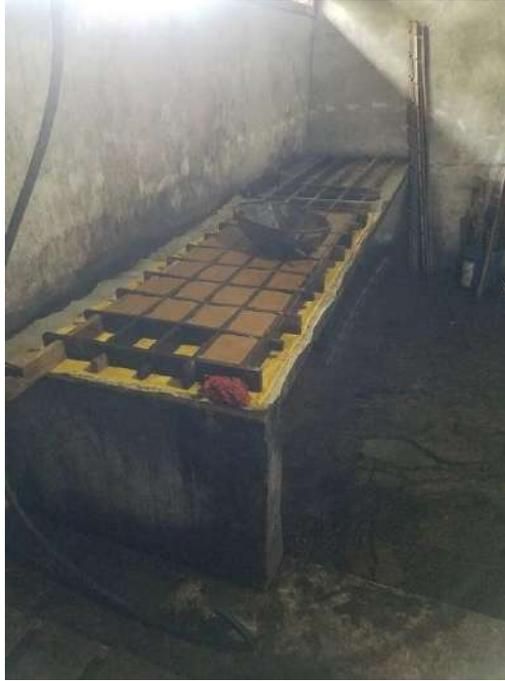
**Figura 15-4:** Moldeo de la panela sólida en bloques
