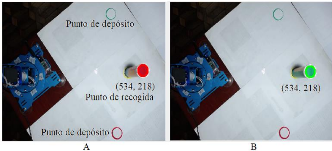
Figura 6-5: Reconocimiento de color con el algoritmo creado en coordenadas específicas. A) Reconocimiento del color rojo. B) Reconocimiento del color verde. Realizado por: Bejarano, L. 2021
