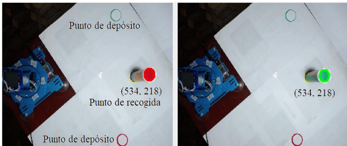
Figura 16-2: Procesamiento de imágenes con MATLAB en el presente trabajo Realizado por: Bejarano, L. 2021
