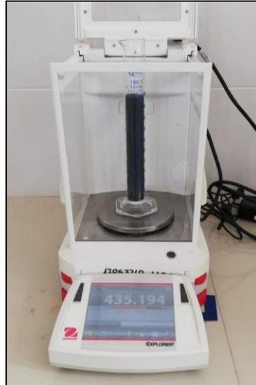
**Figura 29 – 3:** Determinación de la densidad aparente.
