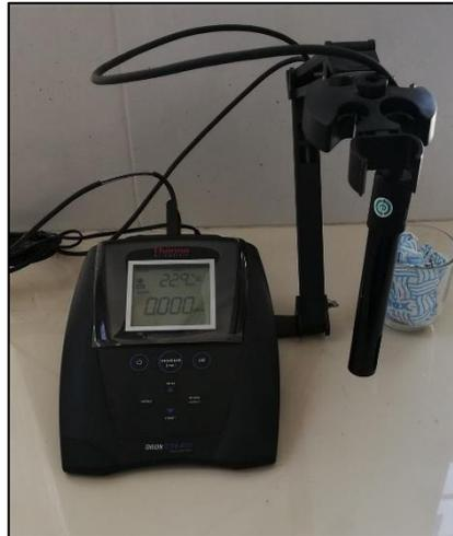
**Figura 26 – 3:** Determinación de la conductividad eléctrica.
