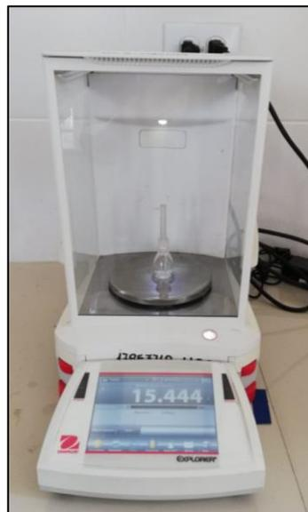
**Figura 30 – 3:** Determinación de la densidad real.
