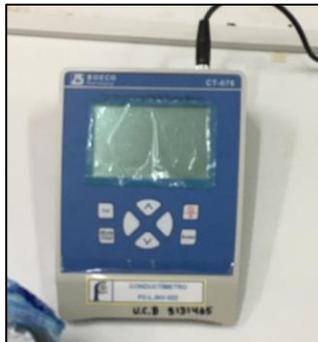
**Figura 1:** Conductímetro
