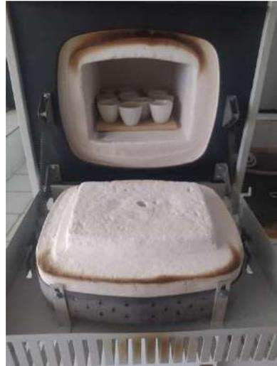
Determinación de cenizas por el método de la mufla
