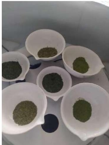
Determinación de humedad por el método gravimétrico
