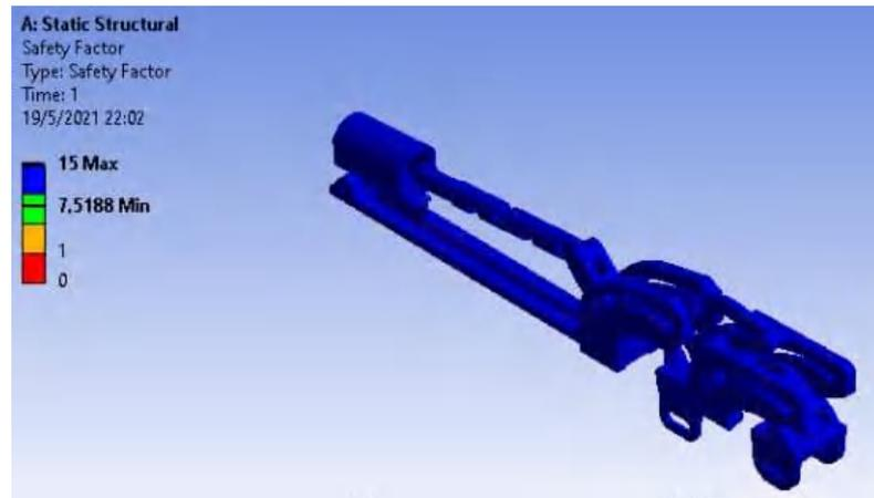
**Figura 3-4:** Factor de seguridad
