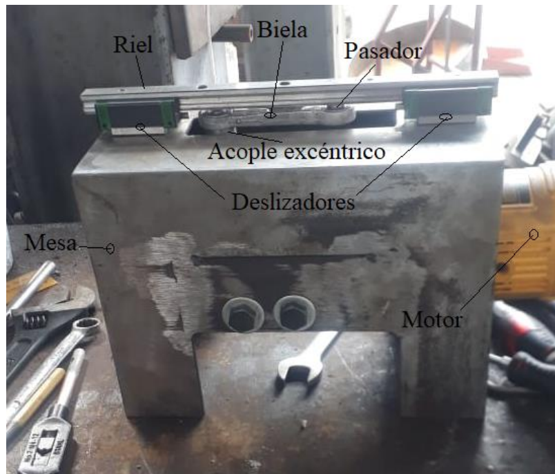
Figura 58-3. Ensamble del mecanismo a la mesa estructural
