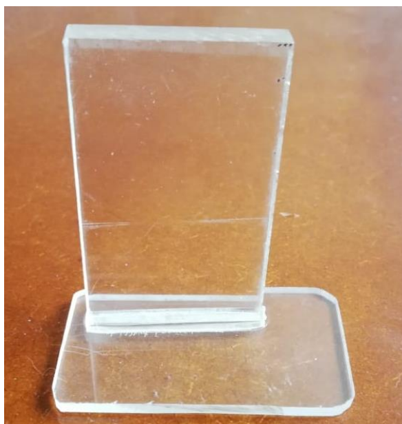
Figura 1-4. Resultado de la soldadura.
