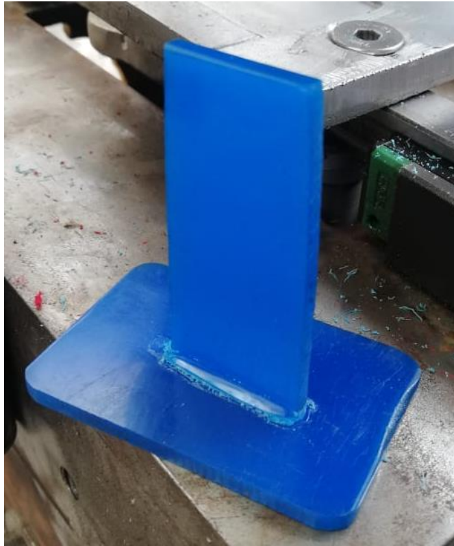
Figura 65-3. Forma de soldadura que se puede obtener con el prototipo de la máquina de la soldadura por fricción lineal.
