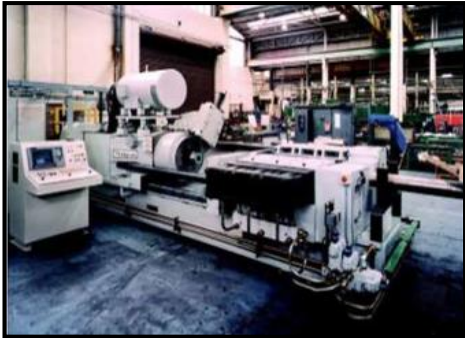
Figura 6-2. Máquina para soldadura por fricción rotacional
