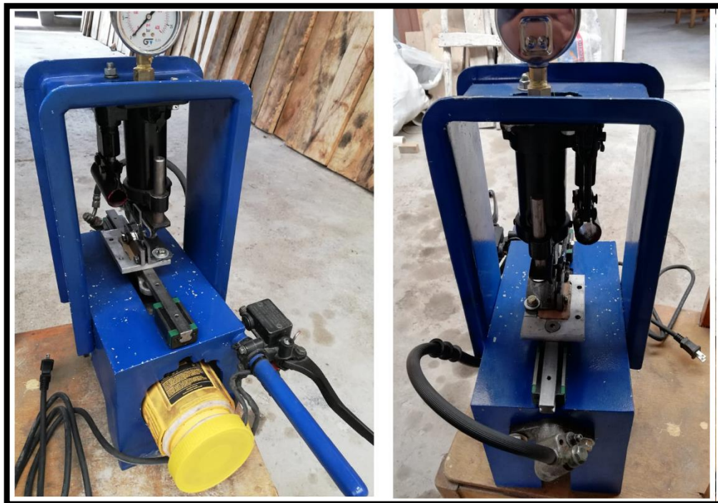
Figura 64-3. Prototipo de máquina de soldadura por fricción lineal de acrílico.
